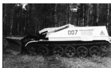
Рис. 1. Лесопожарный агрегат АЛТ – 55, выпускавшийся Уссурийским танкоремонтным заводом: А – в транспортном положении, Б – в рабочем положении
