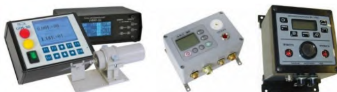
Рис. 2. Стационарные приборы непрерывного контроля радиационной обстановки
