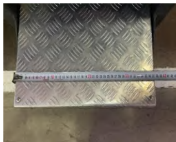
Рис. 7. Вид площадки подножки у отсека с пожарными рукавами с указанием конкретных размеров
