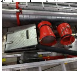
Рис.4. Схема заправки водой головного автомобиля от АЦ по одному магистральному рукаву при наличии крышки (люка)
