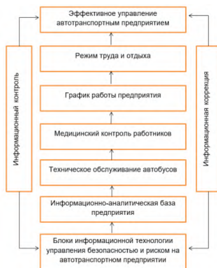
Рис. 2. блоки информационного контроля управления безопасностью и риском на автотранспортном предприятии
