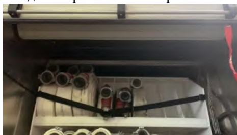
Рис.4. Механизм сматывания рольставни (дверь-шторы) в пожарном отсеке
