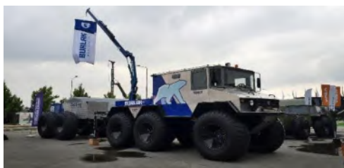
Рис. 4. Расположение крановой установки на шасси вездехода «Бурлак»
