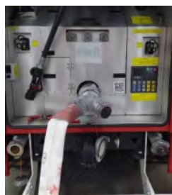
Рис.5. Схема заправки водой головного автомобиля от АЦ по одному магистральному рукаву в полость пожарного насоса с установкой водосборника и одной пожарной соединительной головки-заглушки
