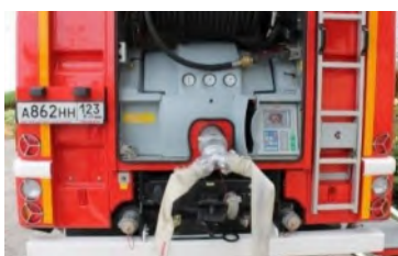
Рис.10. Схема заправки водой головного автомобиля от АЦ по двум магистральным рукавам с применением водосборника
