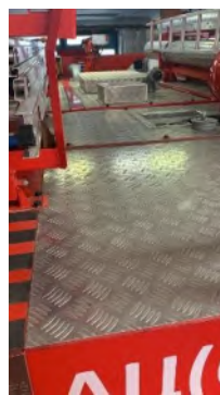
Рис. 6. Вид подножек и покрытие крыши пожарного автомобиля, выполненных из рифленого металла
