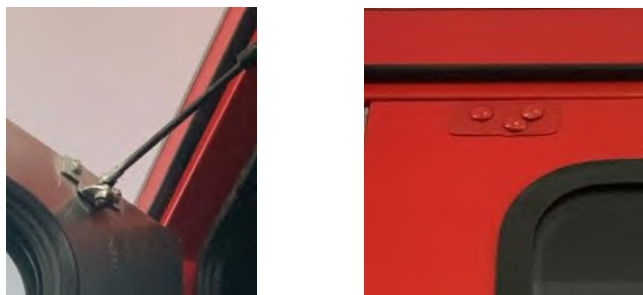
Рис. 10. Вид крепления (фиксации) ограничителя открывания дверей кабины боевого расчета, усиленный уже в подразделении
