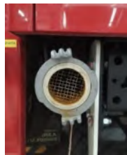
Рис.9. Вид металлической сетки в дополнительном патрубке
