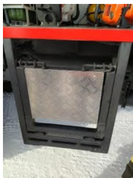
Рис. 6. Вид подножек и покрытие крыши пожарного автомобиля, выполненных из рифленого металла
