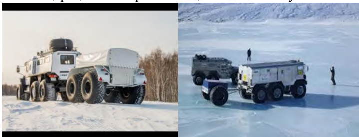
Рис. 2. Виды прицепов для вездехода «Бурлак»
