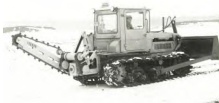
Рис. 2. Орудие дренажное навесное ОДН – 1500
