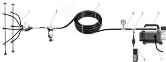
Рис. 5. Рабочий комплект системы дистанционного контроля газовой обстановки аварийных участков шахт (в упрощенном виде):
