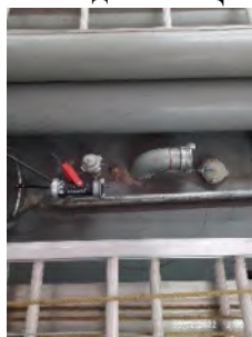
Рис.6. Схема заправки водой головного автомобиля от АЦ по одному магистральному рукаву при наличии на крыше пожарного автомобиля патрубка (сухотруба) с муфтовой пожарной соединительной головкой
