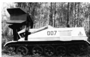
Рис. 1. Лесопожарный агрегат АЛТ – 55, выпускавшийся Уссурийским танкоремонтным заводом: А – в транспортном положении, Б – в рабочем положении
