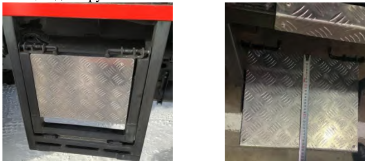
Рис. 5. Вид устройства фиксации площадок подножек
