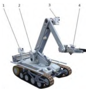
Рис. 1. Варианты расположения камер на мобильном комплексе (1-4)
