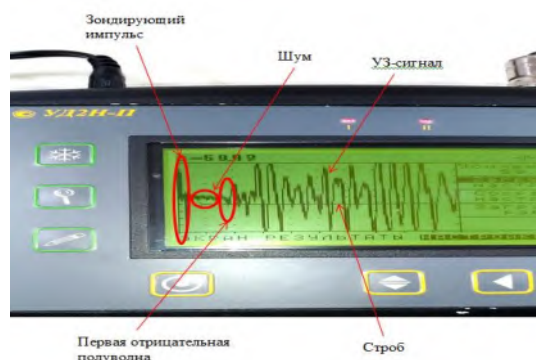
Рис. 2. Схема сигнала выводимого на экран ультразвукового прибора
