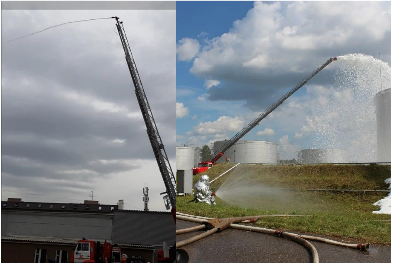
Рисунок 64. Работа лафетного ствола слева, ГПС-600 справа
