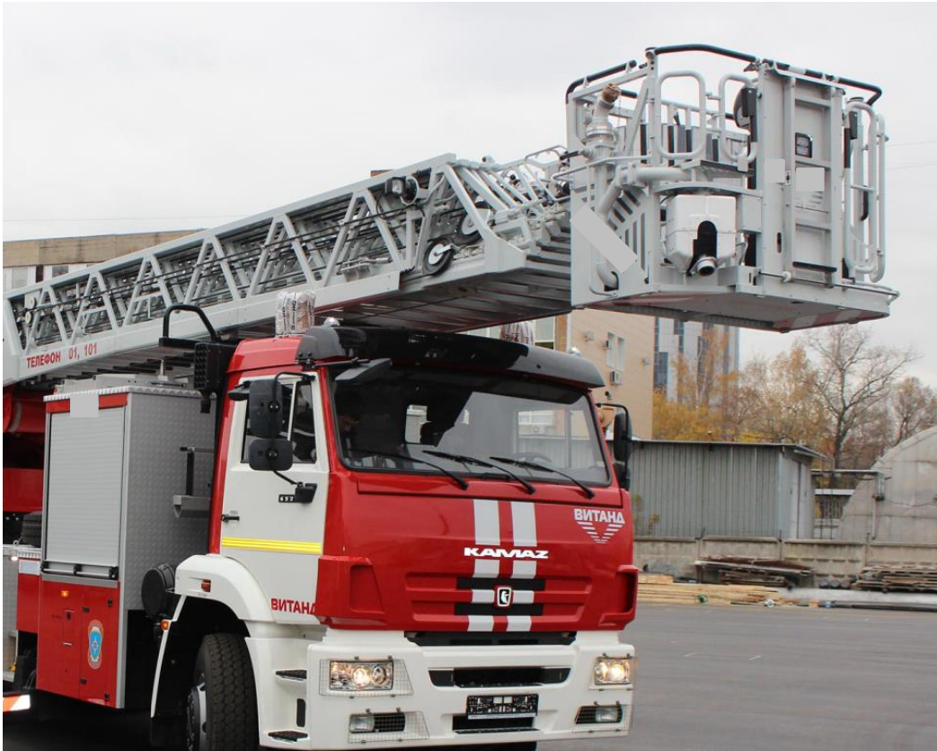
Рис. 40 Люлька на вершине первого колена в транспортном положении на примере АЛ-55 (6520)-В5
