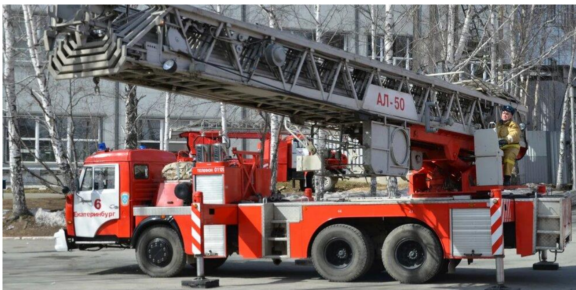
Рис.6 Использование пожарной автолестницы в качестве грузоподъемного крана
