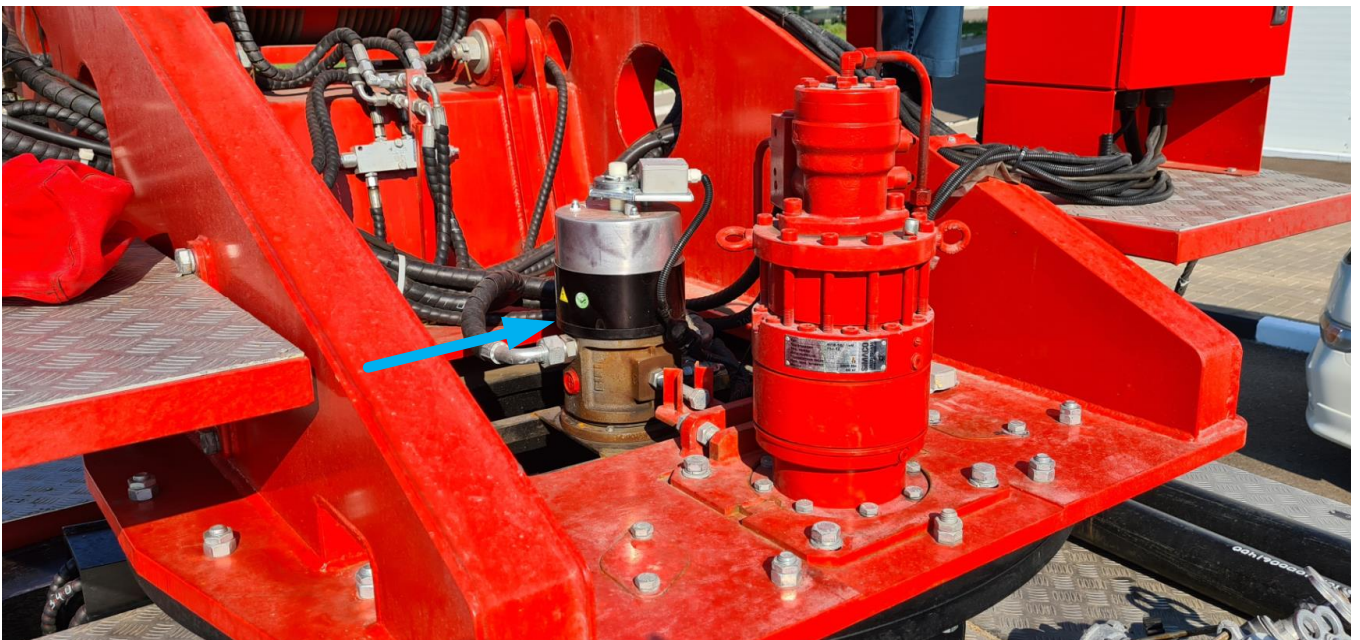
Рис. 32 Осевой коллектор на примере АЛ-30 (43502) 01А-СМ
