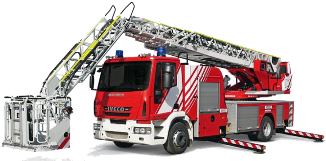
Рис. 35 Пожарная автолестница с шарнирным соединением комплекта колен на примере Magirus-M-32-L-AT
