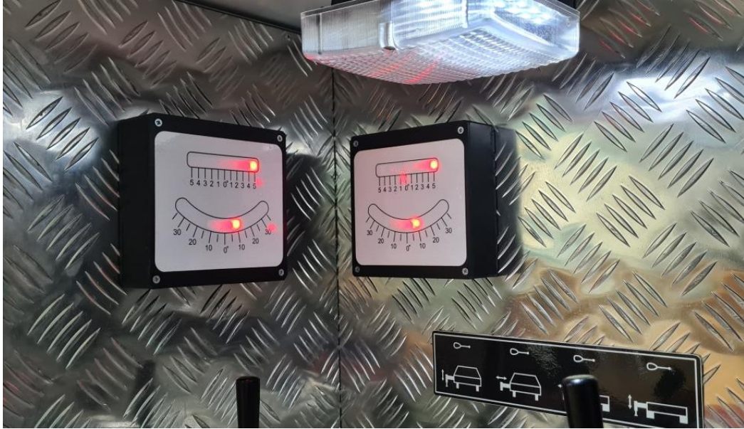
Рис. 20 Измерители уровня продольного и поперечного крена опорного основания на примере АЛ-50 ПМ – 513А
