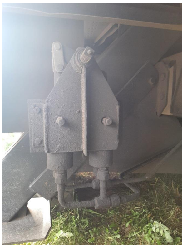
Рисунок 65. аварийный привод с ручным насосом (ручной насос типа ГН-200М) на примере АЛ-30 ПМ-506
