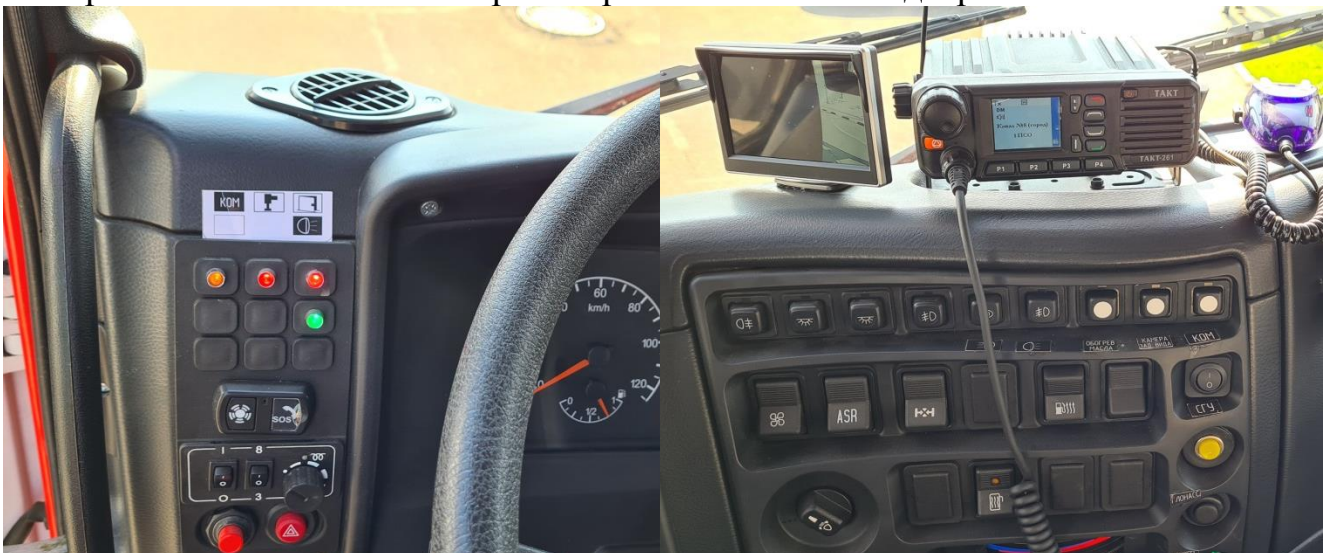
Рис. 43 Щиток контроля водителя на современных моделях пожарных автолестниц (располагается в кабине водителя) на примере АЛ-30 01А-СМ
