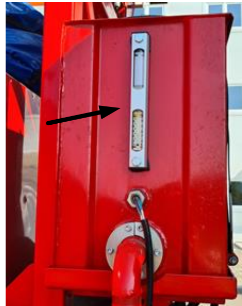
Рис. 16 Указатель уровня масла с термометром со шкалой деления от 0 до 100°С, показывающий температуру в сливной линии гидросистемы
