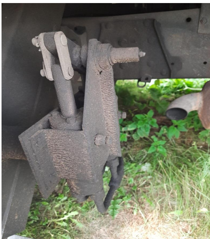
Рисунок 65. аварийный привод с ручным насосом (ручной насос типа ГН-200М) на примере АЛ-30 ПМ-506
