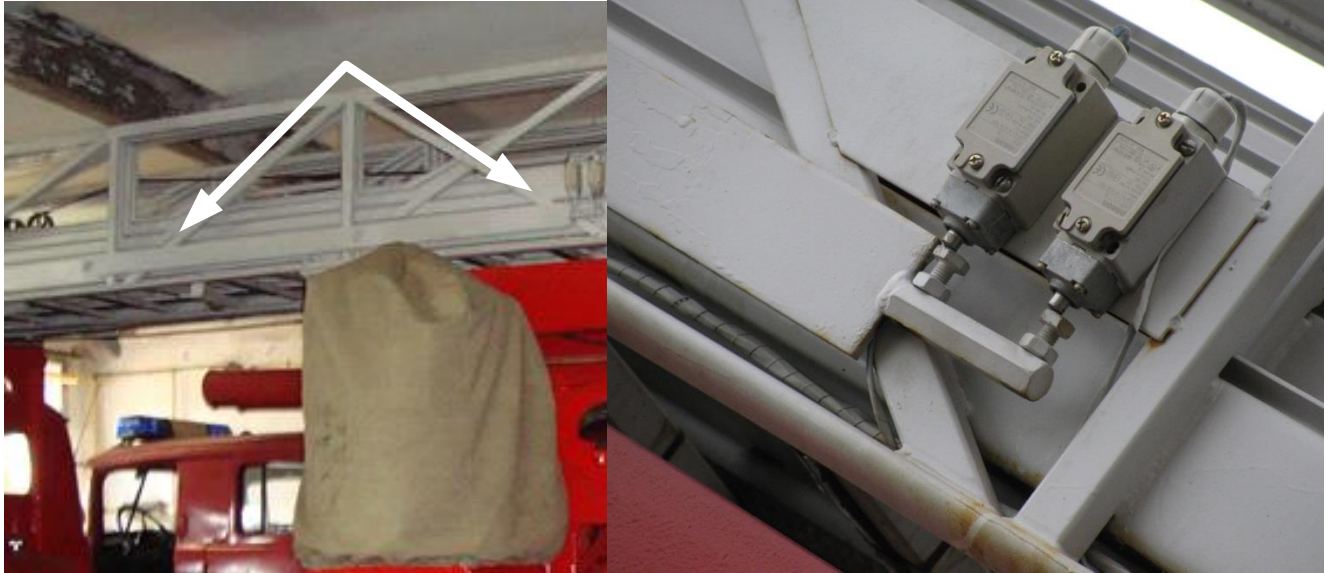
Рис. 21.1 Устройство перегруза лестницы на примере АЛ-30 ПМ-506
