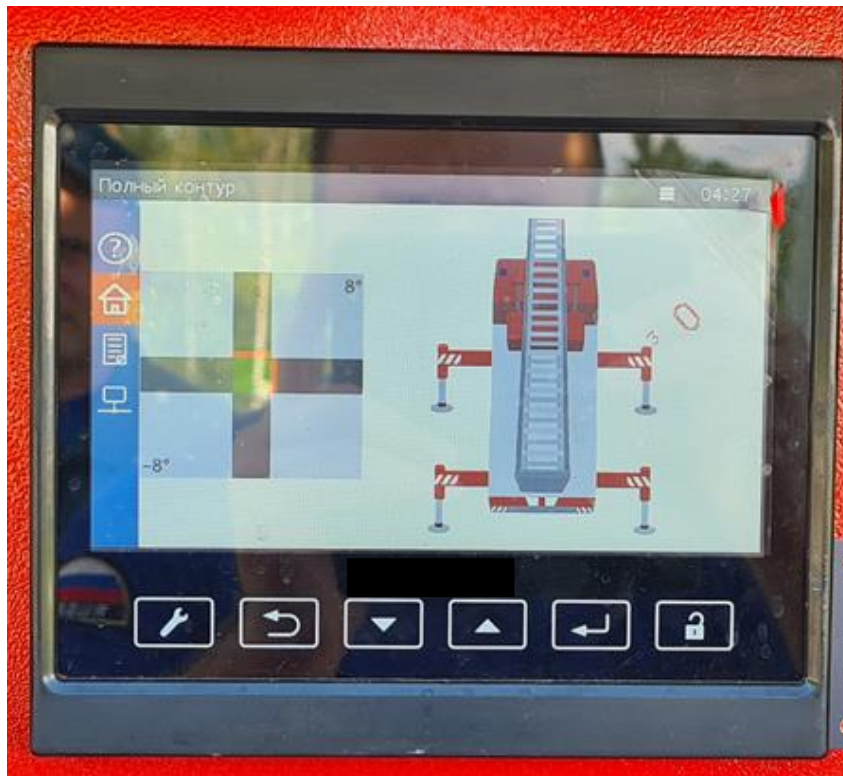
Рис. 20.1 Измерители уровня продольного и поперечного крена опорного основания на примере АЛ-30 01А-СМ
