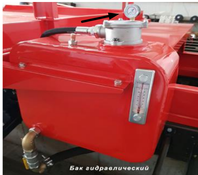
Рис. 14 Манометр на сливном фильтре масляного бака
