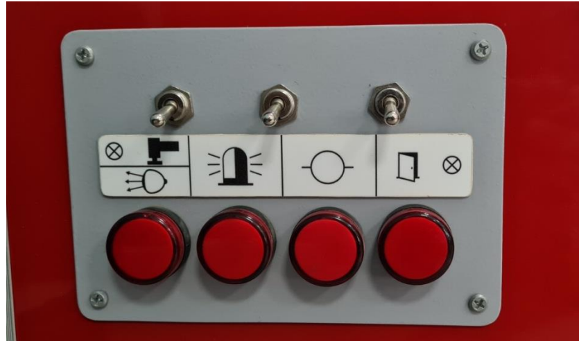
Рис. 44 Щиток контроля водителя на более устаревших моделях пожарных автолестниц (располагается в кабине водителя)
