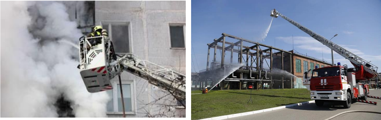
Рис.7 Подача огнетушащих веществ с помощью пожарной автолестницы
