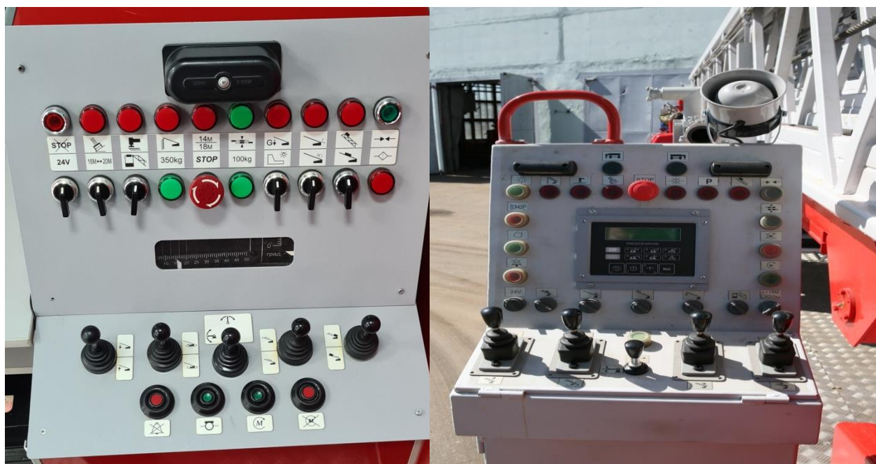
Рис. 48 Основной пульт оператора на более устаревших моделях пожарных автолестниц (установлен на поворотном устройстве)
