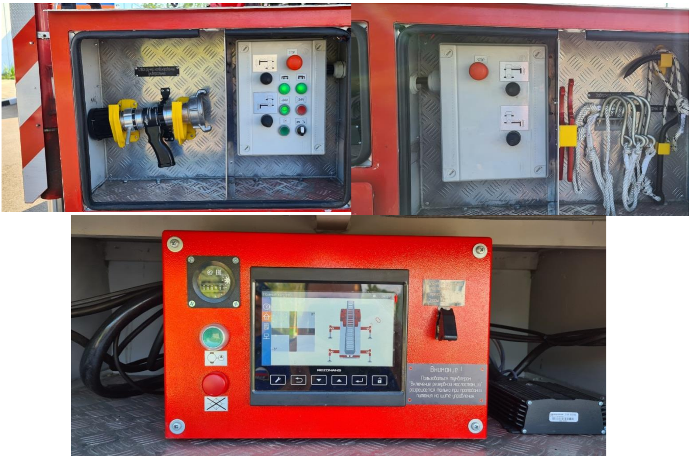
Рис. 45 Пульт управления опорами на современных моделях пожарных автолестниц (располагается в задней части платформы (несущая рама)) на примере АЛ-30 01А-СМ
