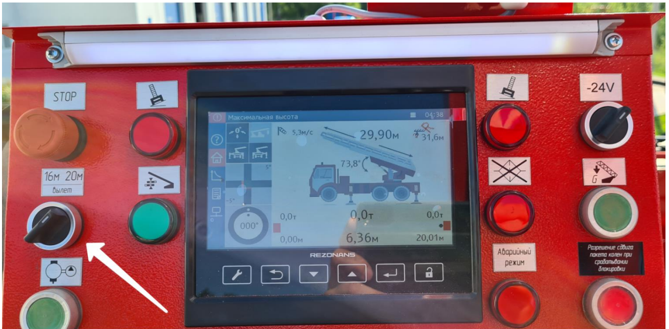
Рисунок 57. Переключатель максимально вылета лестницы
