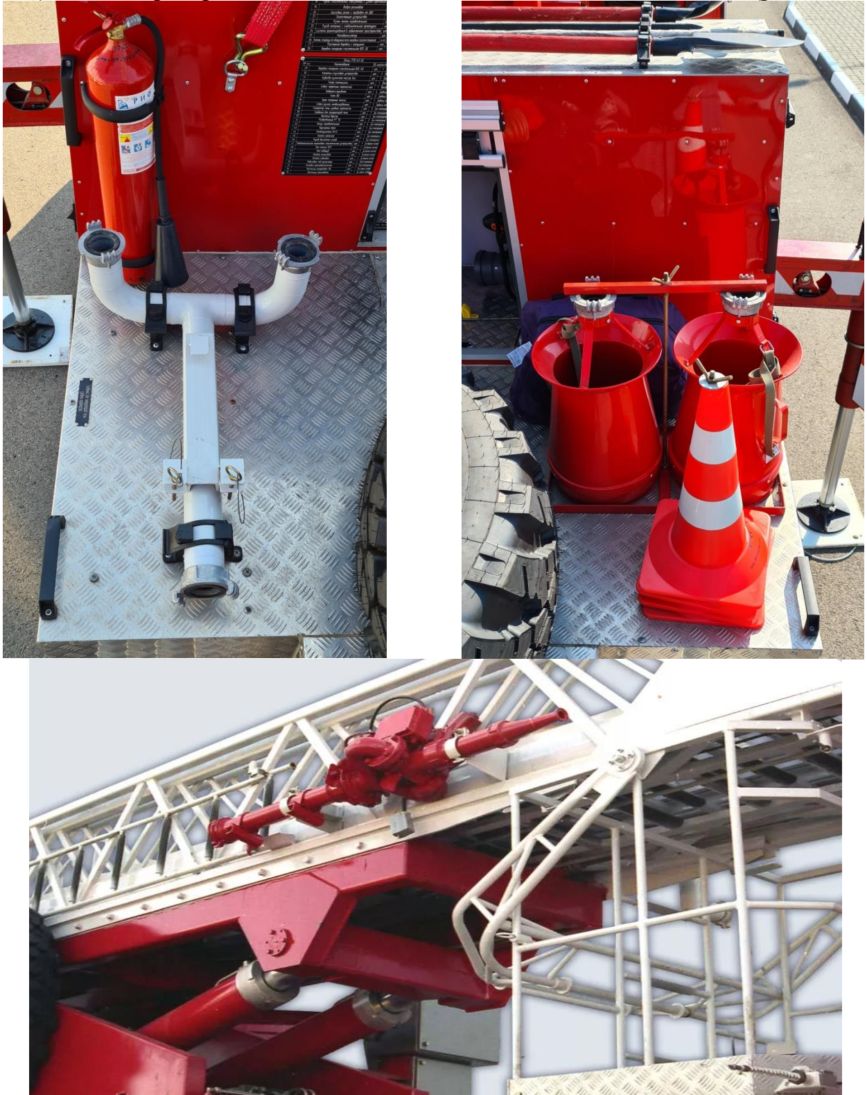
Рисунок 62. Штатный лафетный ствол, гребёнки с двумя пеногенераторами, входящими в комплектацию автолестницы
