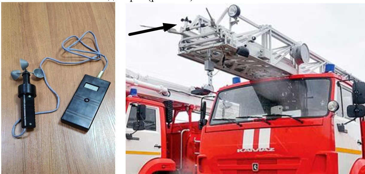
Рис. 19 Анемометр переносной слева и стационарный справа для измерения скорости ветра используемый на пожарных автолестницах
