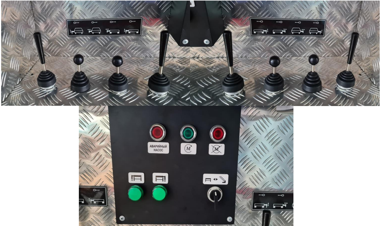
Рис. 46 Пульт управления опорами на более устаревших моделях пожарных автолестниц (располагается в задней части платформы (несущая рама))
