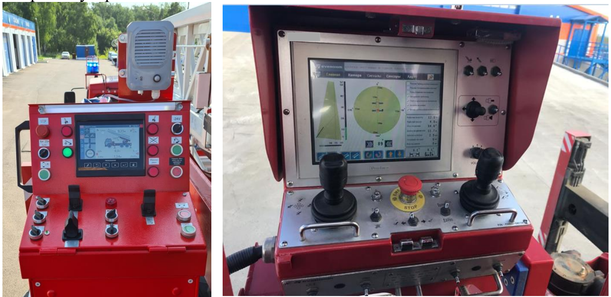
Рис. 47 Основной пульт оператора на современных моделях пожарных автолестниц (установлен на поворотном устройстве)
