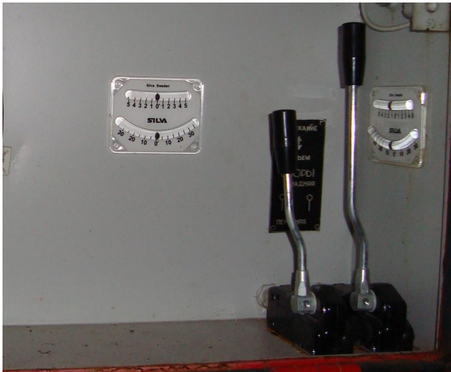
Рис. 20.2 Измерители уровня продольного и поперечного крена опорного основания на примере АЛ-30 ПМ – 506Д
