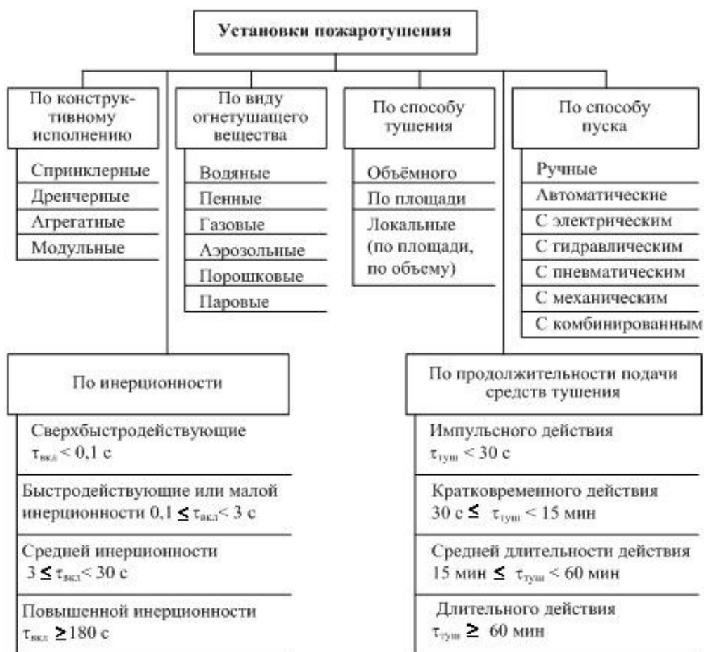
Рис. 8.1 Обобщенная классификация автоматических установок пожаротушения
