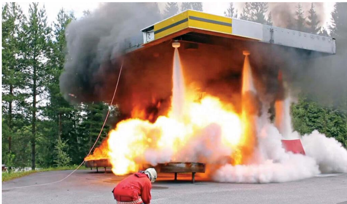
Рис. 10.1 Тушение пожара АУПП
