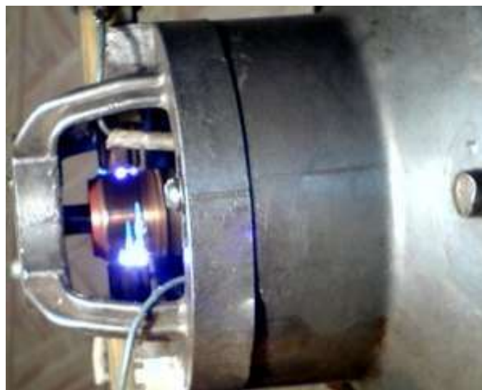
Рисунок 9 – Искрение в контактно-щеточном механизме электродвигателя
