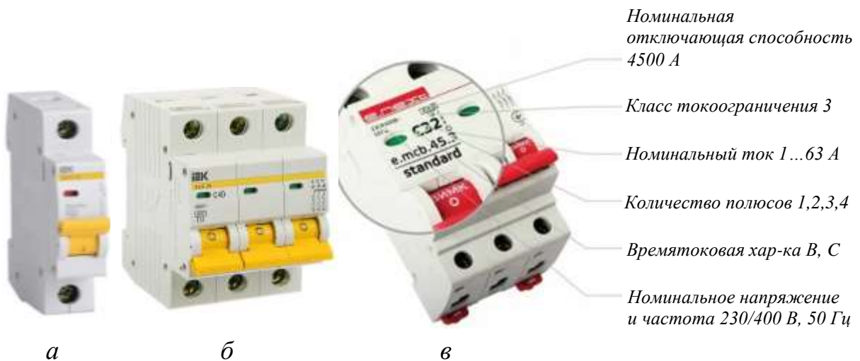
Рисунок 25 – Внешний вид автоматического выключателя: a – однополюсной; б – трехполюсной; в – обозначение характеристик автоматического выключателя на его корпусе
