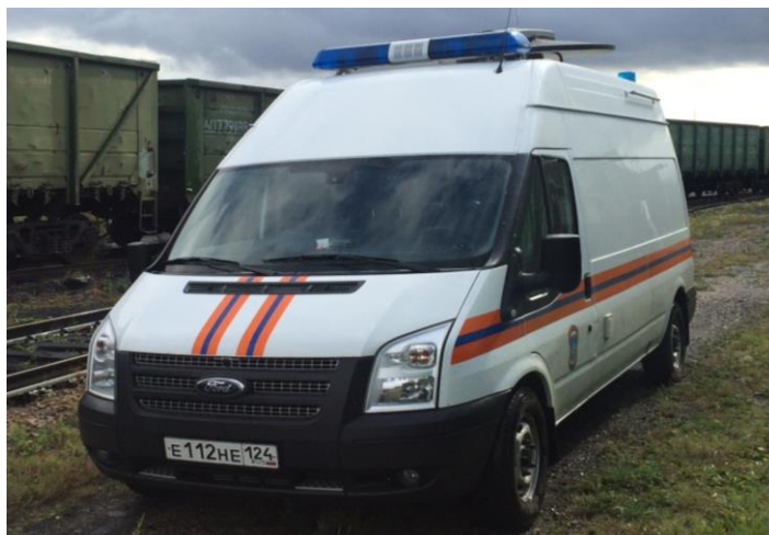
Рисунок 50 – Радиометрическая лаборатория на базе Ford Transit LWB
