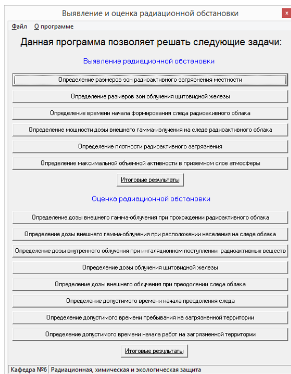
Рисунок 80 – Интерфейс компьютерной программы «Методика оценки радиационной обстановки при разрушении ядерного энергетического реактора на атомной станции»
