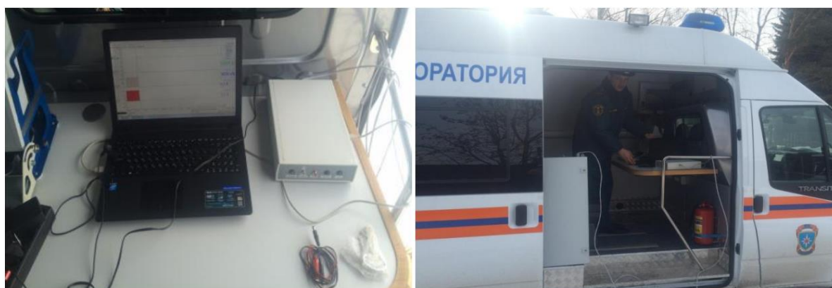
Рисунок 53 – Комплекс дозиметрического контроля «СИММЕТ»
