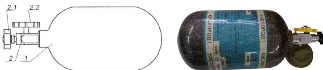
1 - баллон; 2 - вентиль; 2.1 - маховичок; 2.2- гайка накладная
