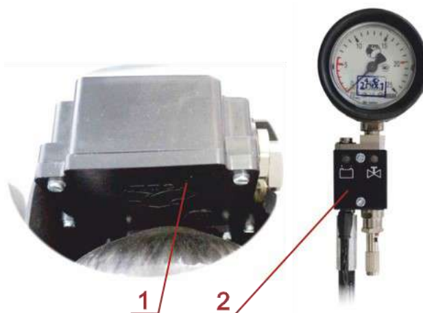
1-сигнальный блок, 2-блок индикации
