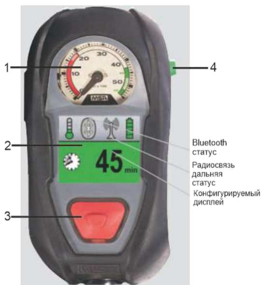
1-аналоговый манометр, 2-цветной дисплей, 3-ручная сигнализация, 5-кнопка сброса Рисунок 101 - Модуль управления
