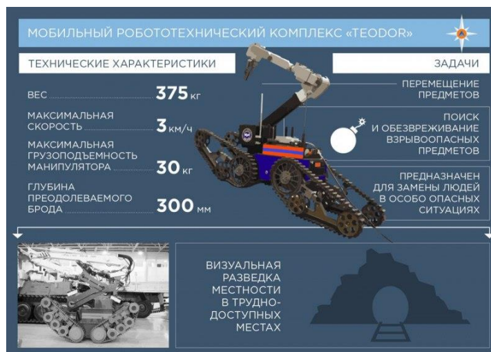
Рис. 8.2.15 – Мобильный робототехнический комплекс «TEODOR» [79]
