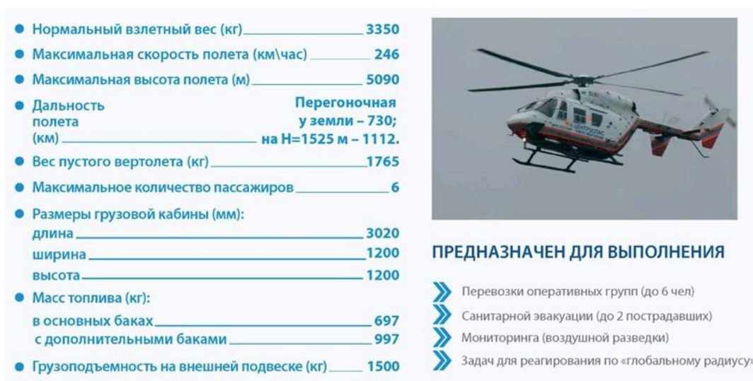
Рис. 8.3.4 – ТТХ вертолета ВК-117 С-1 [80]
