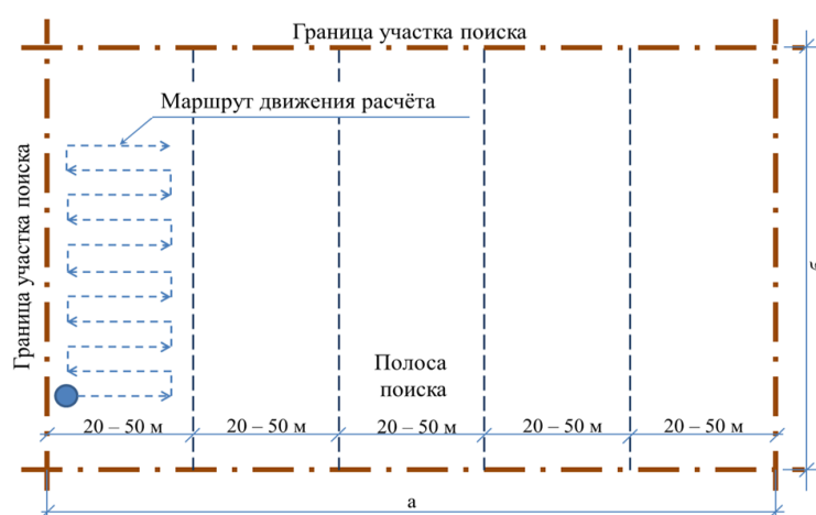
Рис. 5.2.1 – Схема движения поисковых расчетов при ведении поиска пострадавших в завалах способом сплошного визуального обследования участка АСР: а – ширина участка поиска; б – длина участка поиска
