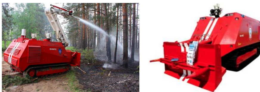
Рис. 8.2.12 – Многофункциональные робототехнические комплексы пожаротушения типа ЕЛЬ-4 (слева) и ЕЛЬ-10 (справа) [78]
