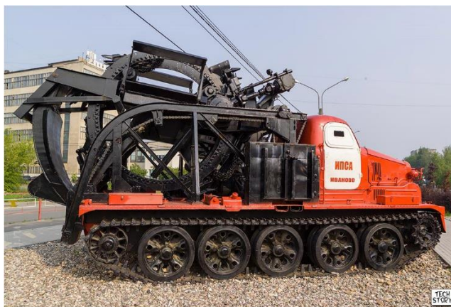
Рис. 8.2.7 – Быстроходная траншейная машина типа БТМ-3 [76]
