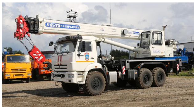
Рис. 8.2.8 – Автокран КС-55713-5В-1 на шасси КАМАЗ-43118 [77]
