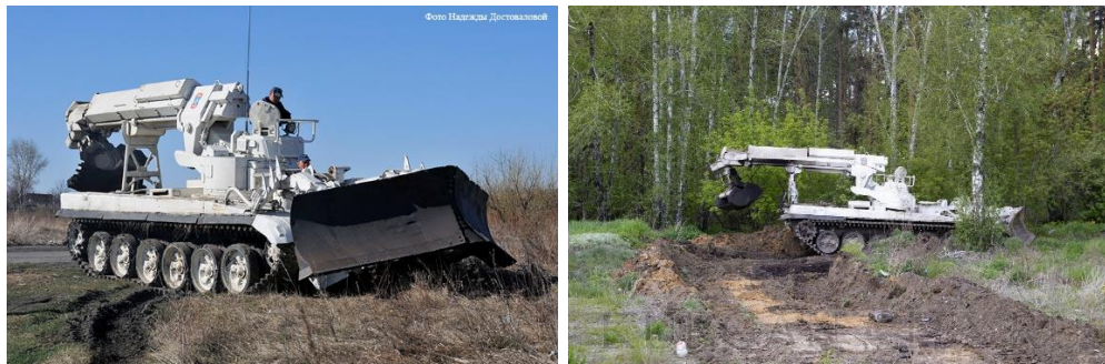
Рис. 8.2.5 – Инженерная машина разграждения типа ИМР-2М [73; 74]
