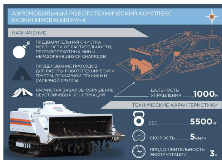
Рис. 8.2.16 – Аэромобильный робототехнический комплекс разминирования MV-4 [79]
