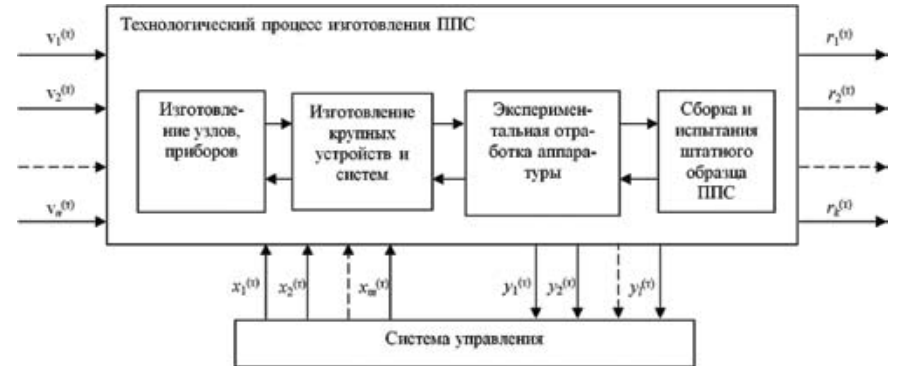
Рис. 3. Обобщённая функциональная схема технологического процесса изготовления ППС
