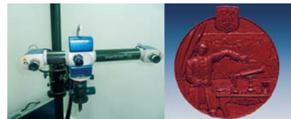
Рис. 3. Цветной трёхмерный сканер SmartSCAN с примером отсканированного художественного барельефа – компьютерная модель
