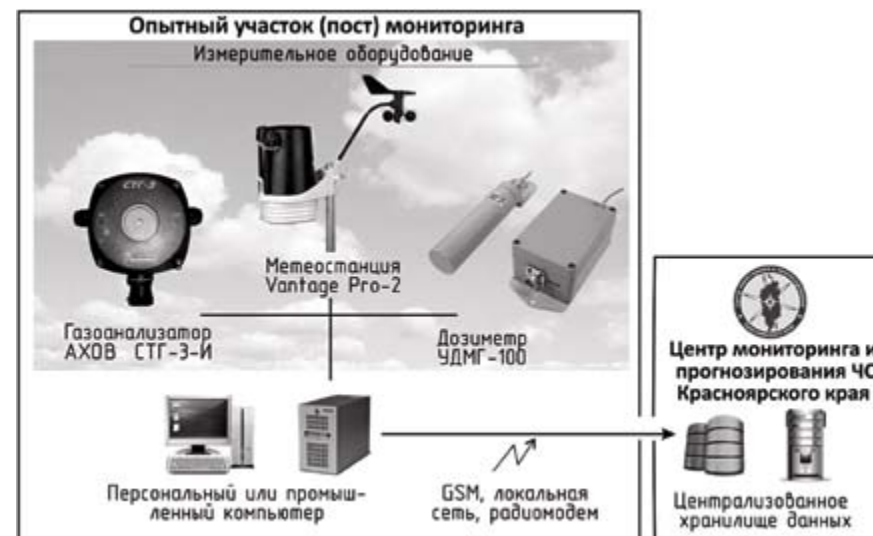
Рис. 2. Состав опытного участка (поста) мониторинга объектов техносферы
