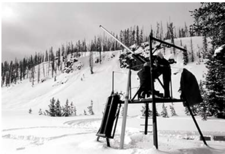
Рис. 3. Пневматическая пушка - «аваланчер» для заброса снаряда на лавину
