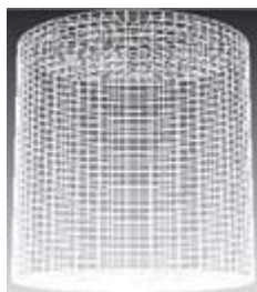
Рис. 1. Расчётная сетка навески кокса
