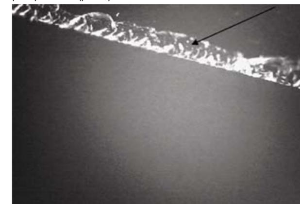
Рис 1. Кромка стекла, образовавшаяся в результате механического разрушения при 50х кратном увеличении.
