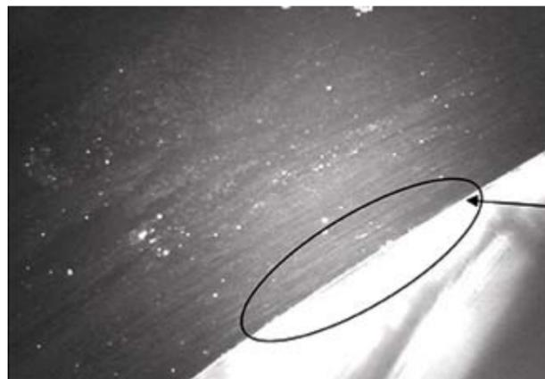
Фото 3. Скол на фрагменте стекла, образовавшийся в результате высокотемпературного воздействия (показан стрелкой).
