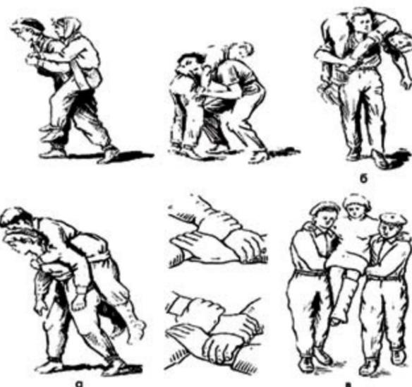
Рис.1. Приёмы переноски пораженного: а) с помощью лямки; б) на себе; в) вдвоём на руках (замком из трех или четырёх рук).
