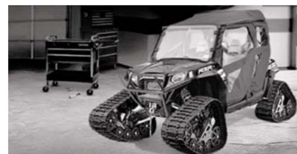
Рис. 2. Мотовездеход МВПС-ПО (Polaris Ranger RZR 4 800 EFI - гусеничный вариант)
