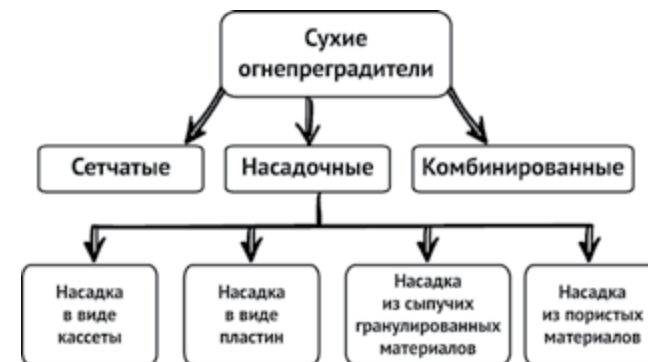
Рис. 1. Классификация сухих огнепреградителей по конструктивному исполнению
