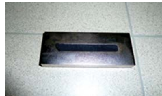
Рис. 5. Вид кристалла ZnSe с пробой угля тления
