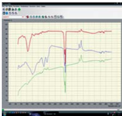
Рис. 6. Вид спектров МНПВО (сверху вниз): 1) образец, не подвергавшийся термическому воздействию, 2) образец, обугленный при температуре 350^{\circ}\text{C} в течение 30 минут, 3) образец, подвергнутый сжиганию
