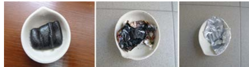
а б в Рис. 3. Внешний вид образцов ПВХ-профиля, подвергнутых нагреванию при различных температурах в течение 30 минут: а) 250 °С; б) 500 °С при ограничении доступа кислорода; в) 500 °С
