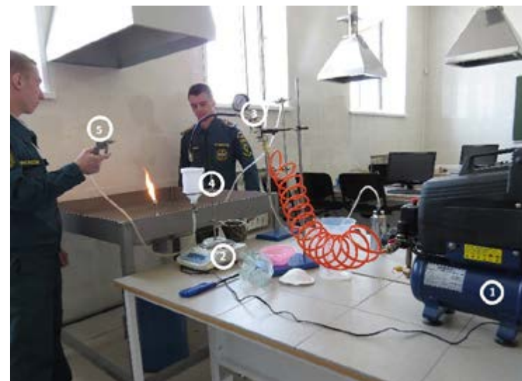
Рис. 1. Схема установки. 1-компрессор сжатого воздуха с автоматическим регулятором давления, 2-весы тензометрические с точностью до 0,01г., 3-пистолет для подачи сжатого воздуха с контрольным манометром, 4-емкость для порошка, 5-трубка подачи с возможностью подключения различных сопел
