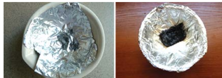
а б Рис. 2. Образцы линолеума после термического воздействия: а) образец 1 температура 500 °С, б) образец 2, температура 250 °С
