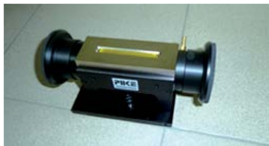
Рис. 2. Приставка МНПВО фирмы «Pike» с закрепленным на ее поверхности кристаллом ZnSe
