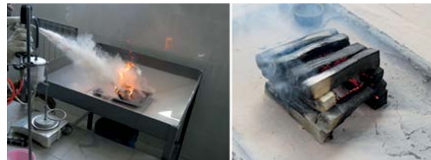
Рис.3. Результат тушения модели пожара класса А1
