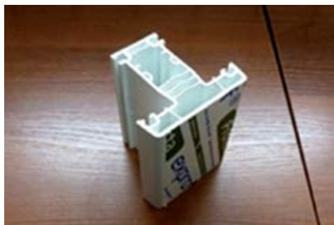
Рис. 1. Фрагмент ПВХ-профиля Profecta
