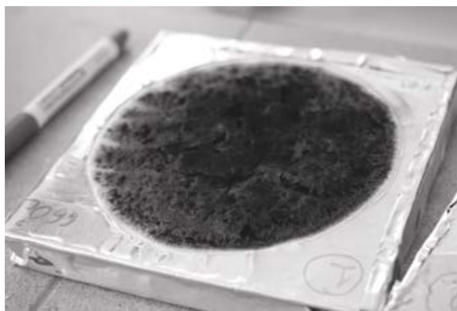
Рис. 3. Образец после испытания (ППТП= 30 кВт/м²)
