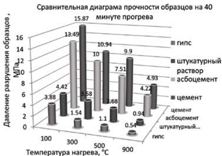
Рис. 2. Результаты испытания образцов строительных растворов на прочность: а – цементного раствора; б – алебаstra; в – штукатурного раствора; г – асбоцемента; д – сравнительная диаграмма прочности образцов на 40 минуте прогрева
