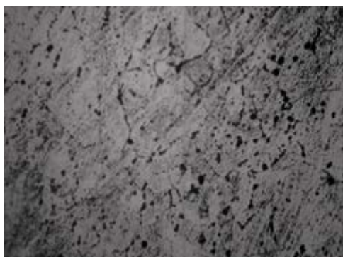
Рис. 5. Медный проводник после воздействия КЗ. (увеличение \times 300 )
