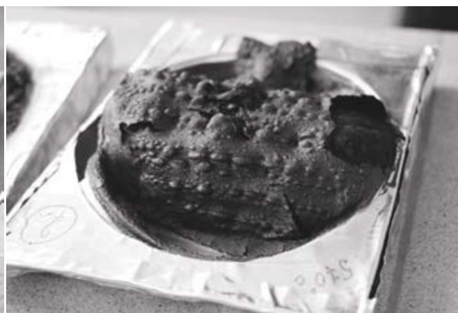
Рис. 4. Образец после испытания (ППТП= 30 кВт/м²)
