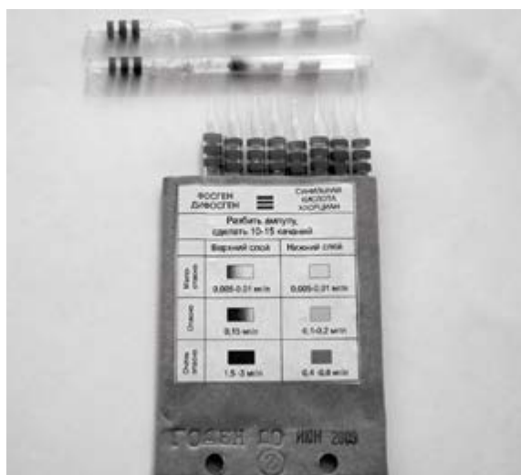
Рис. 5. Индикаторные трубки из комплекта ВПХР (вверху – контрольная, внизу – после анализа отходящих газов)
