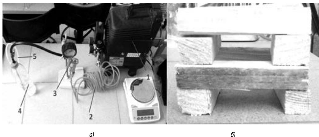
Рис.3. Используемые материалы и оборудование: а) лабораторная установка для подачи огнетушащей жидкости, б) макет очага класса А1
