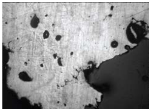
Рис. 7. Зона оплавления проводника после КЗ
