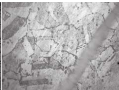
Рис. 6. Медный проводник после воздействия КЗ. (увеличение \times 500 )
