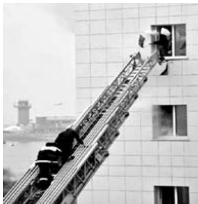
Рис.1. Применение автолестницы для эвакуации людей из горящего здания
