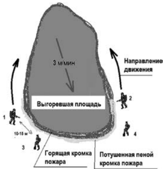
1 и 2- рабочие на тушении, 3 и 4 – рабочие на окарауливании потушенной кромки и подноске жидкости Рис. 2. Схема локализации лесного низового (или весеннего травяного) пожара низкой интенсивности с применением проектного орудия
