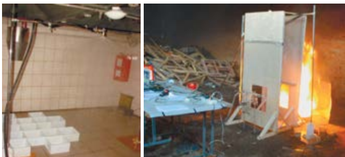
Рис. 1. Общий вид исследований: а – измерение параметров работы оросителей; б – исследование изменения теплового потока под воздействием распыленной воды
