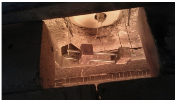
Рис. 6. – Испытание неизолированного узла подвески огнестойкого воздуховода
