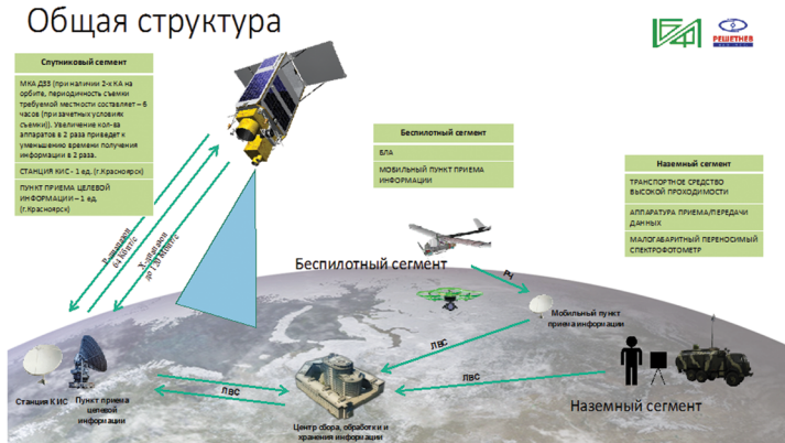
Рис. 1. Общая структура Трёхсегментной системы мониторинга.
