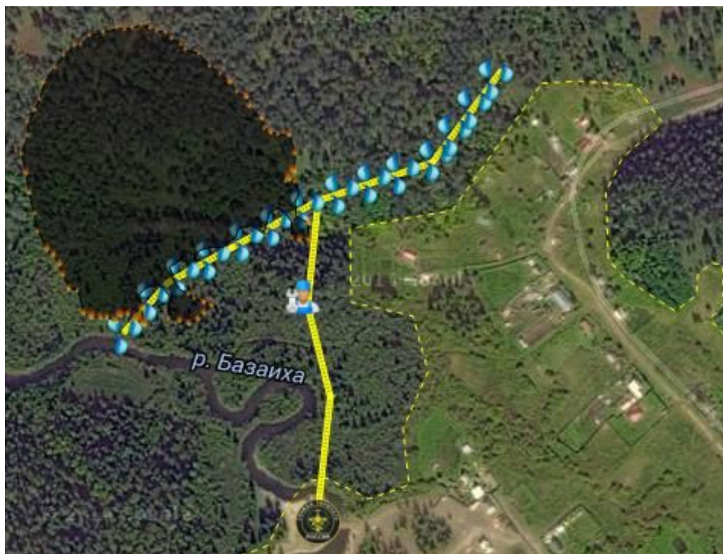
Рис. 5. Подача воды и прорыв пожара за линию трубопровода, вследствие неправильного планирования точек сброса воды
