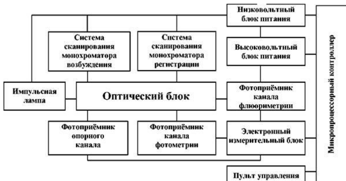
Структурная схема «Флюорат-02- Панорама»
