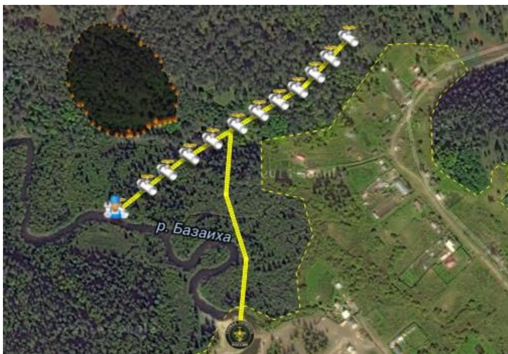
Рис. 4. Раскладка трубопровода в линию и установка точек сброса воды
