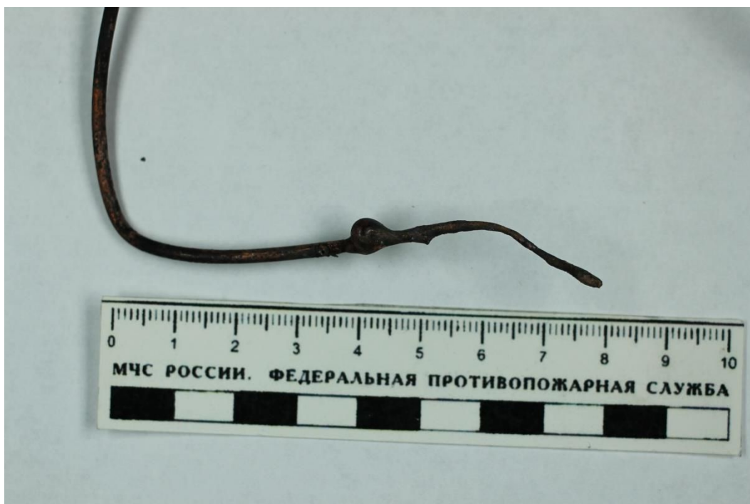
Рис. 1. Медный проводник, изъятый с места пожара
