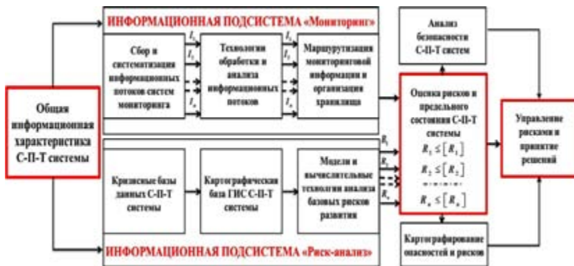
Рис. 1. Информационная система территориального управления рисками и безопасностью (ИСТУ РБ). Общая блок-схема
