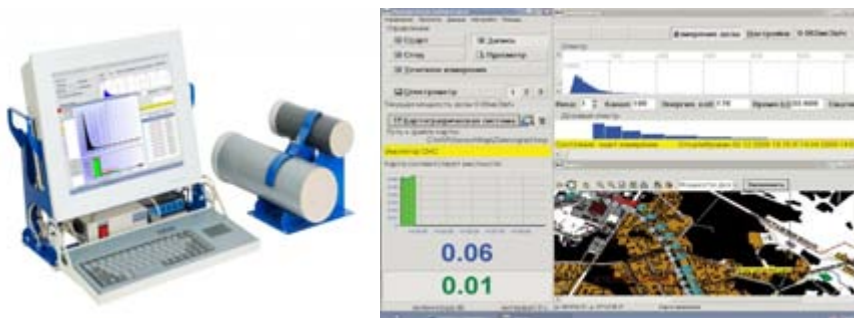
Рис. 3. Внешний вид и вариант отображения данных дозиметрической установки «Гамма-сенсор»
