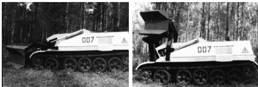
А Б Рис. 1. Агрегат лесопожарный танковый АЛТ-55 в рабочем (А) и транспортном (Б) положениях.
