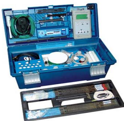
Рис.1. Переносная комплект-лаборатория «Обь».
