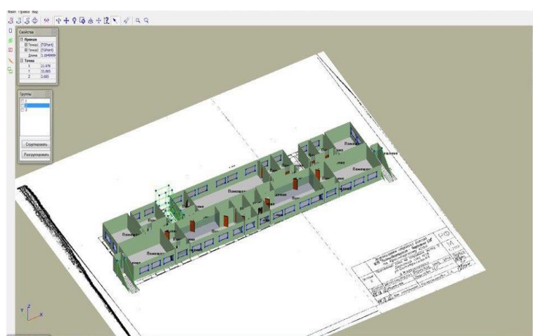
Рис.2. Построение второго этажа
