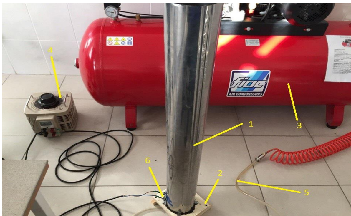
Рис.1. Установка для исследования горения и взрыва аэрозолей.
