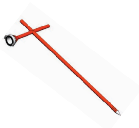
Рис. 6 Ствол-пробойник для подачи ОВ в труднодоступные места
