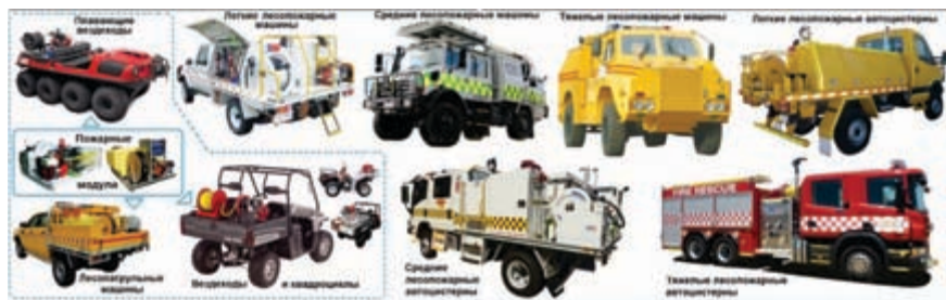
Рис. 1. Спектр колесной самоходной техники для прямого тушения пожаров в природной среде водой и водными растворами (на примере Австралии). Пунктиром выделена группа легкой пожарной техники, применяемой преимущественно для патрулирования территории (квадроциклы, машины, и легкие вездеходы) с емкостями для воды до 1 т.
