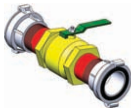
Рис. 5 Перекрывное устройство для новых стволов
