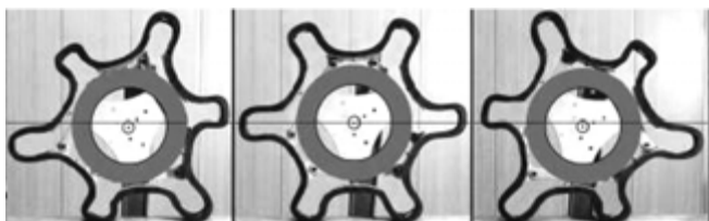
Рис.4. Экспериментальная модель КШД с минимизированными рассогласованиями показателей движения в колесной и шаговой фазах: а, б, в – соответственно начало, середина и конец шаговой фазы движения
