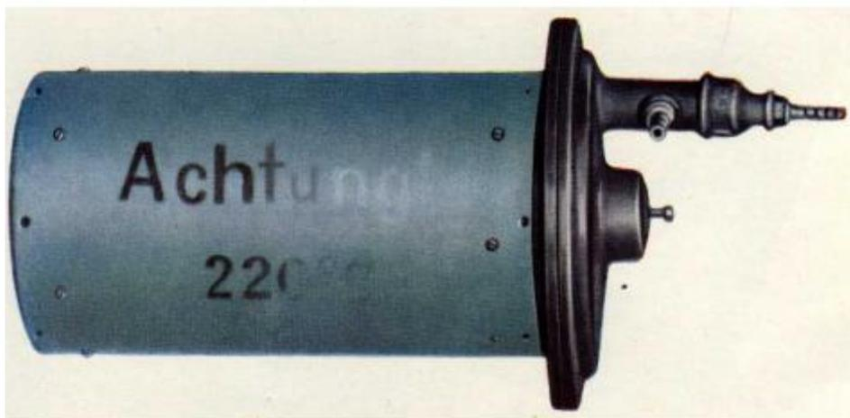
*Рисунок 3 - Использование термохромных красок для индикации нагретой до высокой температуры поверхности оборудования*
