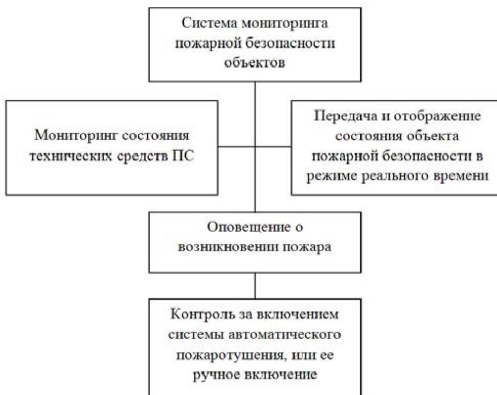
*Рисунок 2 – Функциональная схема системы мониторинга пожарной безопасности объектов*
