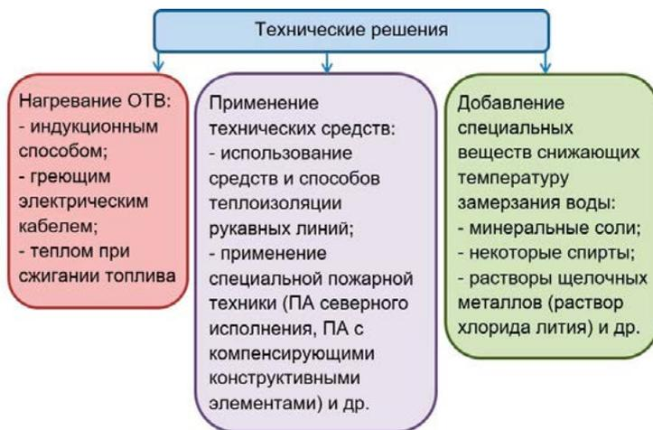
*Рис. 2. Основные технические решения по предотвращению замерзания воды в рукавных линиях*
