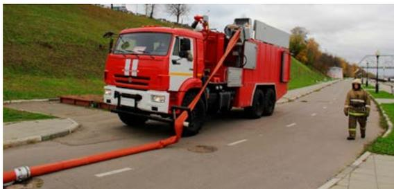
*Рис. 9. Насосно-рукавный комплекс «Поток» при сборе рукавной линии*
