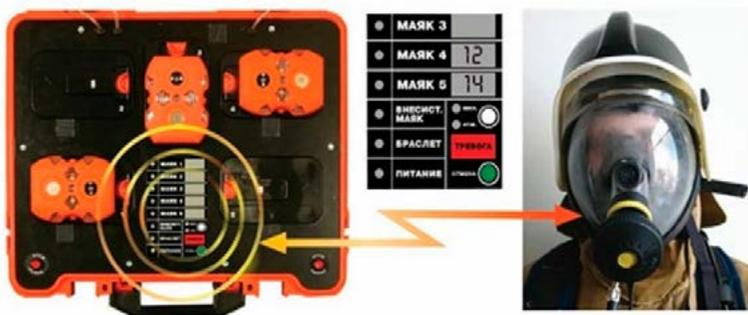
Рис. 5. Контроль давления и запаса воздуха каждого из газодымозащитников
