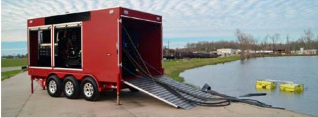
Рис. 3. Использование гидравлических погружных насосов Dual 5000
