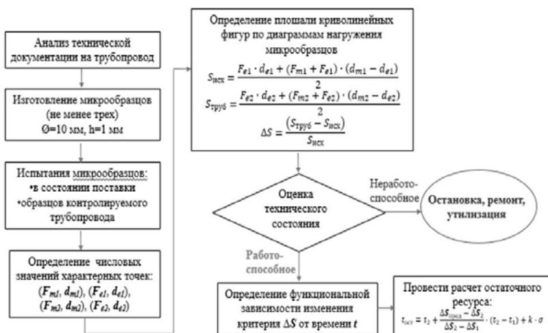
Рис. 3. Алгоритм оценки остаточного ресурса нефтегазового оборудования
