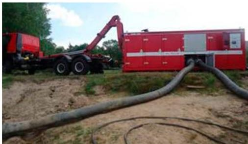
Рис. 10. Насосно-рукавный комплекс модульный «Шквал» в работе
