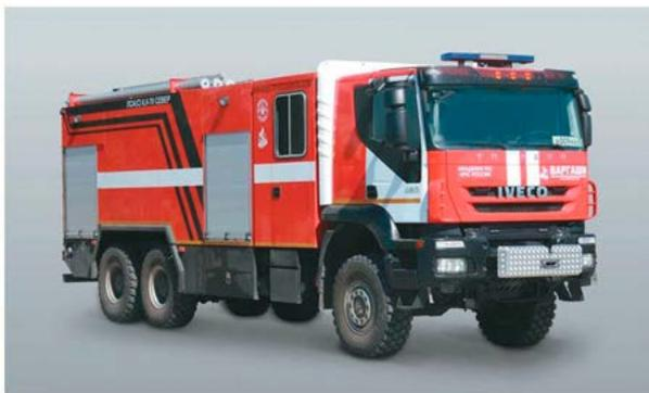
*Рис. 3. Пожарно-спасательный автомобиль повышенной холодоустойчивости*
