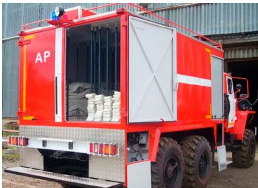
*Рис. 8. АР 1,9/2,8 (5557) – вид со стороны рукавного отсека*
