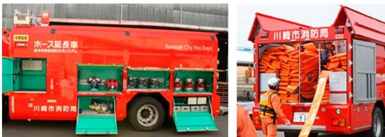
Рис. 6. Развертывание рукавного автомобиля
