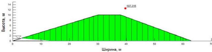
Рис. 2. Определение коэффициента устойчивости (эксперимент 1)
