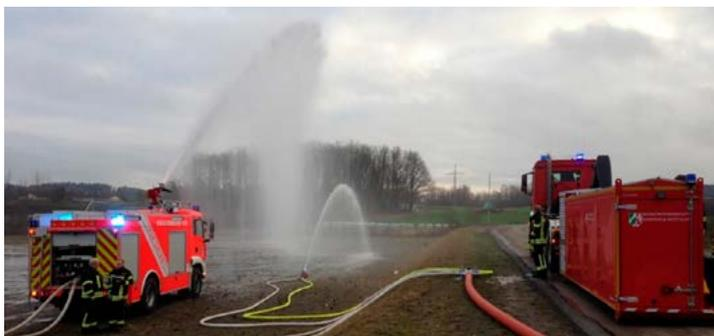
*Рис. 1. Использование WLF32 с АВ-НФС. Подача воды лафетными стволами (переносным и автомобильным)*
