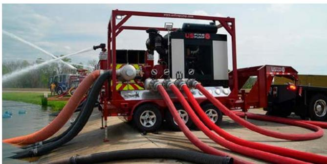
*Рис. 2. Использование мобильной насосной системы USFP 6250 GPM*
