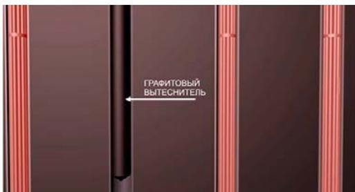
Рис. 11. Схема расположения регулирующих стержней
