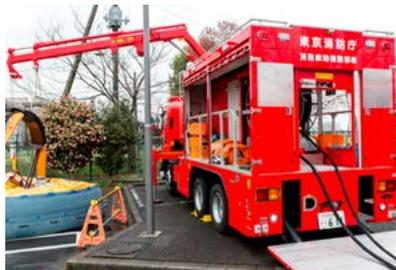
Рис. 5. Установка погружных насосов водовоза дальнего действия
