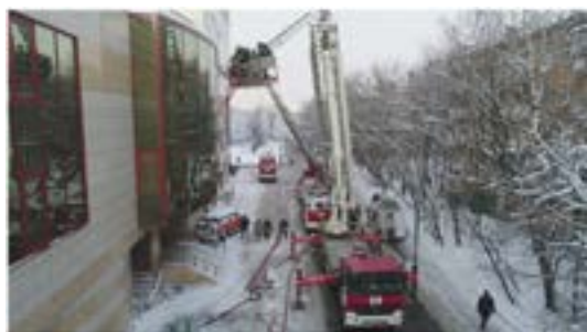
Рис. 2. Подъезд спецтехники к зданию параллельно фасаду
