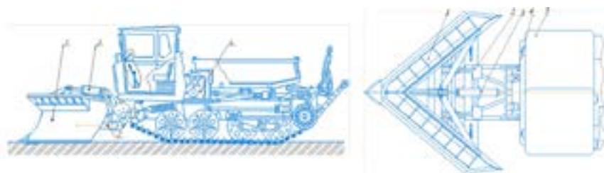
А - вид сбоку 1 - отвал, 2 - навеска, 3 - гидроцилиндр наклона, 4 - трактор ЛХТ-100,
