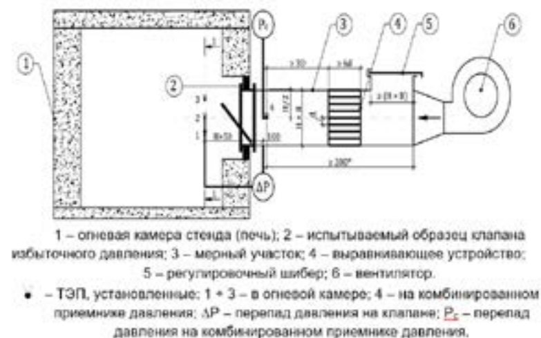
Рис. 5. Схема стенда для проведения испытаний на огнестойкость клапана избыточного давления
