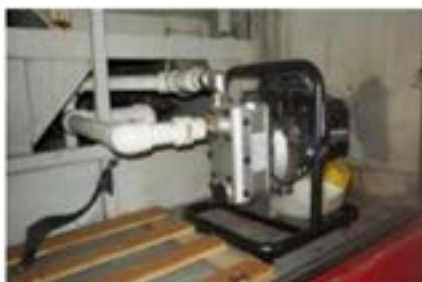
Рис.3. Крепление мотопомпы в отсеке пожарного автомобиля
