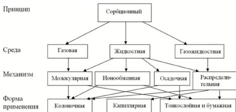
Рис.1. Классификация хроматографических методов анализа
