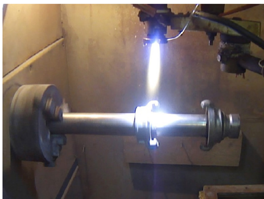
Рис.1 Плазменное напыление порошка ПГСП-4 на соединительную головку
