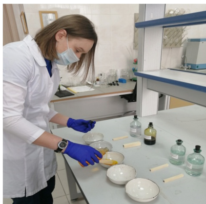
Рис. 2. Пропитка древесных образцов окислителями
