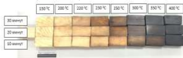
Рис. 1. Вид образцов древесины после термического воздействия «Составлено автором»
