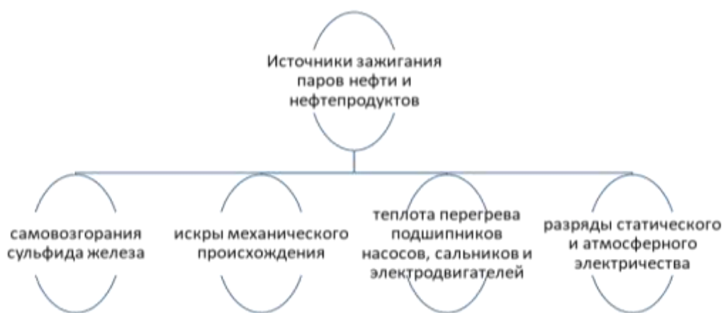
Рис. 1. Источники зажигания паров нефти и нефтепродуктов.
