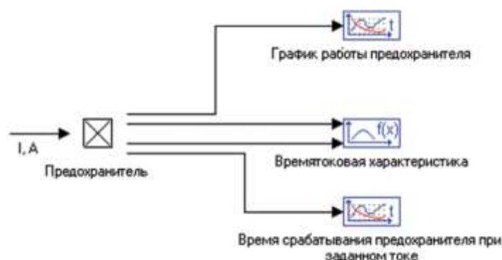
Рис. 4. Фрагмент имитационной модели предохранителя. Источник: Составлено авторами
