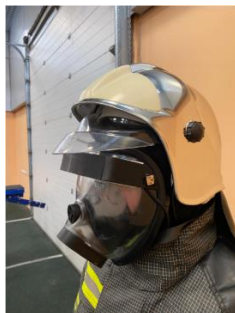
Рис. 1. Пожарный информационно-тепловизионный комплекс «ПОИТЕК»
