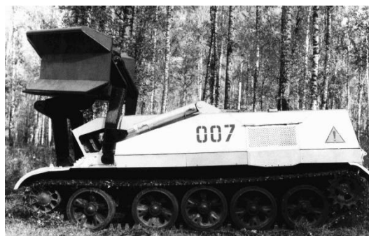
Рис. 1. Агрегат лесопожарный танковый АЛТ-55 в рабочем (А) и транспортном (Б) положениях.
