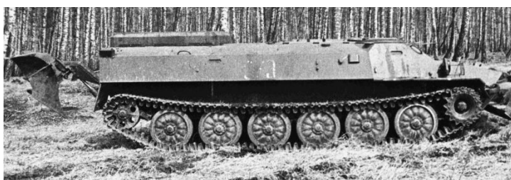
Рис. 3. Лесопожарный агрегат АЛП-57 на базе АСУ-57
