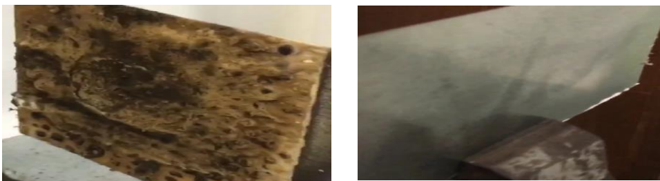
а б Рис. 2. Внешний вид защищенной поверхности от пенококса пластины (а) и обратной стороны (б)
