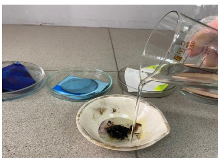
Рис.3. Растворение остатков с места пожара
