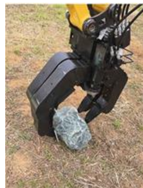
Рис. 7. «Механическая рука» с четырьмя пальцами
