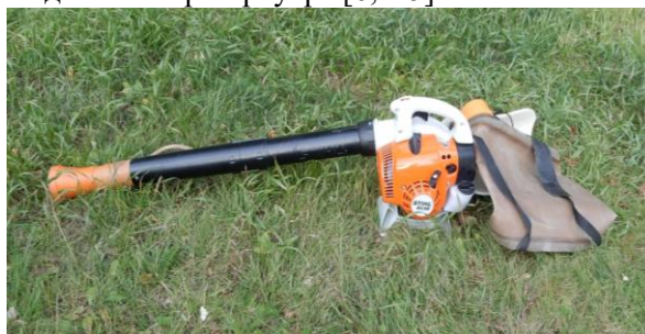
Рис. 2. Устройство для тушения низового лесного пожара и прокладки пенных опорных полос
