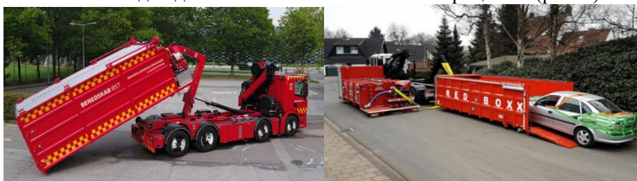
Рис. 2. Пожарный автомобиль с контейнером для погружения электромобиля
