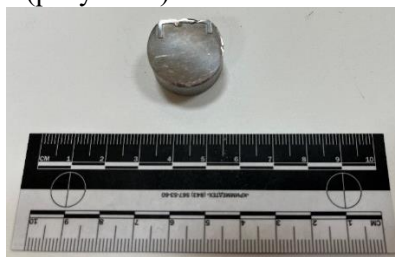
Рис. 2. Шлиф образца №1 с наплывами меди и стали по краям.
