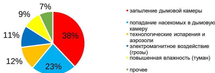
Рисунок. Причины ложных срабатываний оптических пожарных дымовых извещателей
