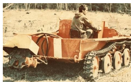
Рис. 3. Лесопожарный агрегат АЛП-57 на базе АСУ-57
