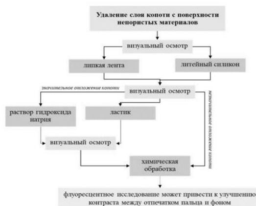
Рис.3. Блок-схема, описывающая удаление слоя копоти с поверхности непористых материалов с целью обнаружения следов рук
