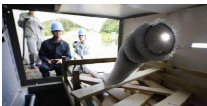
Рис. 3. Робот-поисковик Active Scope Camera
