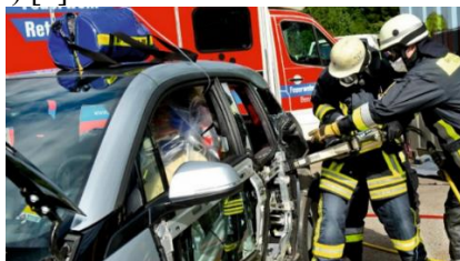
Рис. 3. Вскрытие гидравлическими расширителями электроавтомобиля
