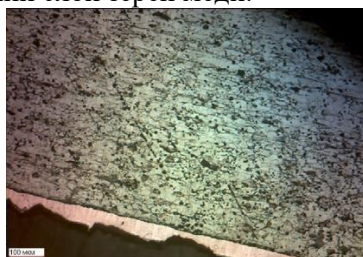
Рис.5. Микроструктура выводного участка образца №2
