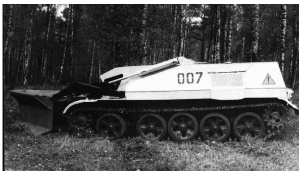
Рис. 1. Агрегат лесопожарный танковый АЛТ-55 в рабочем (А) и транспортном (Б) положениях.
