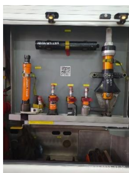
Рис.2 Вариант получения информации, размещенной в электронном справочнике, посредством сканирования смартфоном QR-кодов, размещенных в отсеках пожарного автомобиля
