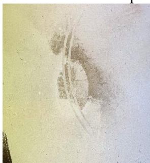
Рис.4 След после удаления копоти в муфельной печи
