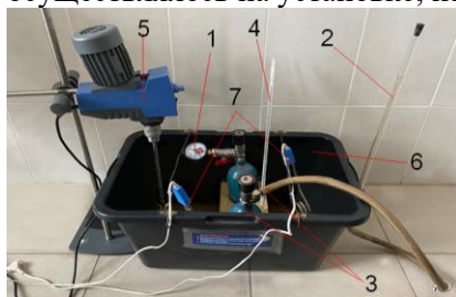
Рис.1. Установка для исследования пожарной опасности повышения давления в нагреваемом аппарате, заполненном горючей жидкостью
