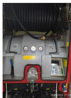
Рис.2 Вариант получения информации, размещенной в электронном справочнике, посредством сканирования смартфоном QR-кодов, размещенных в отсеках пожарного автомобиля
