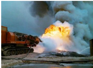
Рис. 2. Тушение пожара пожарным танком с подачей газоводяного потока
