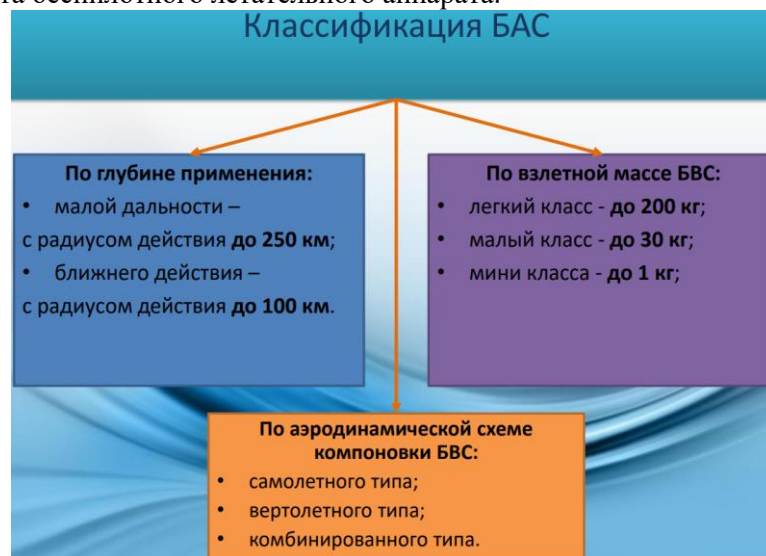
Рис.2. Классификация беспилотных авиационных систем. Источник: [5].
