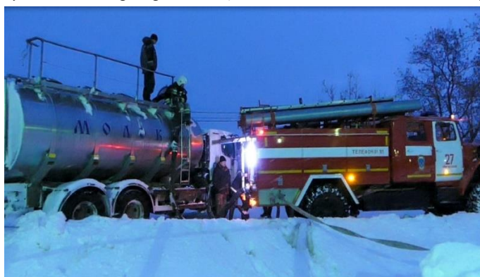
Рис.3. Перекачка доставленной воды насосом, установленным на приспособленной технике для нужд пожаротушения
