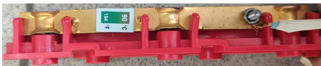
Рис.6. Реакция наклейки на нагрев контактной пластины до 90 °С
