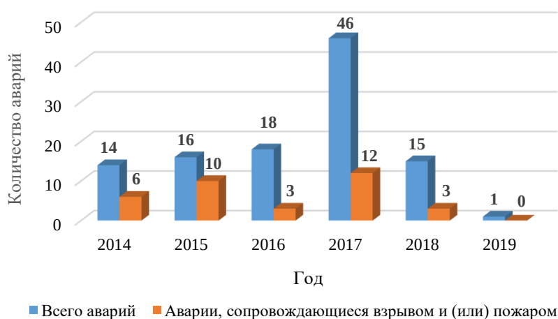
Рис.1. Количество аварий на объектах газораспределения и газопотребления с 2013 по 2019 гг. Источник: Составлено авторами.
