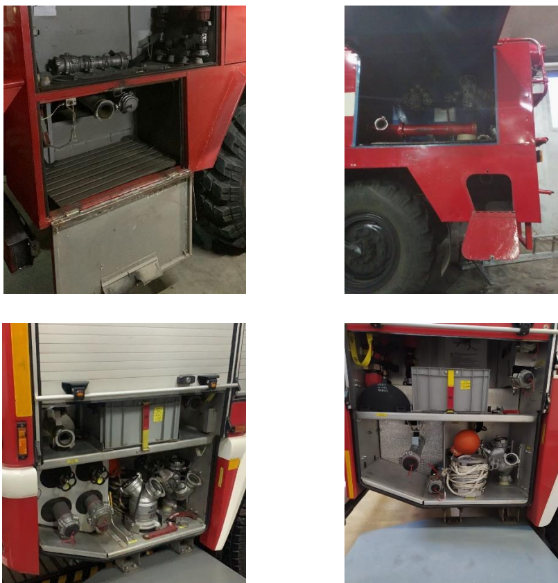
Рис.3.Примеры размещения напорных патрубков пожарных насосов автоцистерн в отдельных отсеках или нишах (люках)
