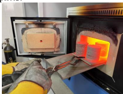
Рис.5. Нагрев образцов в муфельной печи. Составлено авторами
