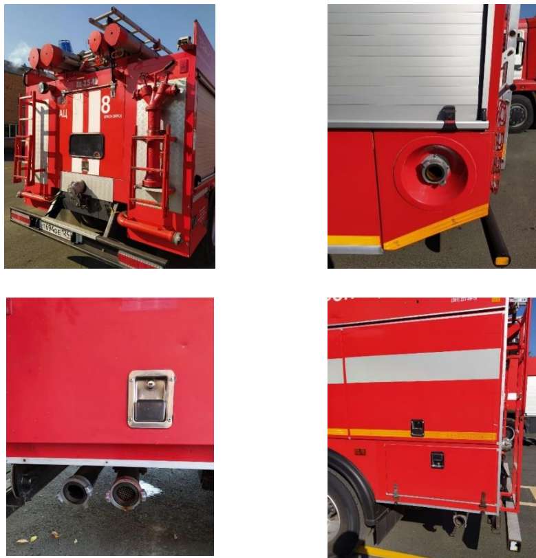
Рис.2. Основные варианты наружного размещения напорных патрубков пожарных насосов автоцистерн
