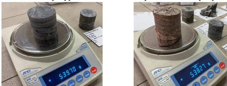
Рис.4. Измерение массы образцов «До» и «После» температурного воздействия. Составлено авторами
