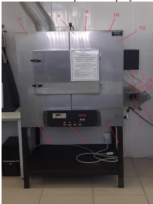
Рис.7. Установка для определения коэффициента дымообразования. Составлено авторами 1 – Камера сгорания; 2 – Держатель образца; 3 – Окно из кварцевого стекла; 4,7 – Клапаны продувки; 5 – Приемник света; 6 – Камера измерений; 8 – Кварцевое стекло; 9 – Источник света; 10 – Предохранительная мембрана; 11 – Вентилятор; 12 – Направляющий козырек; 13 – Запальная горелка; 14 – Вкладыши; 15 – Электронагревательная панель.
