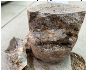
Рис.7. Керн, нагретый до 1000°C
