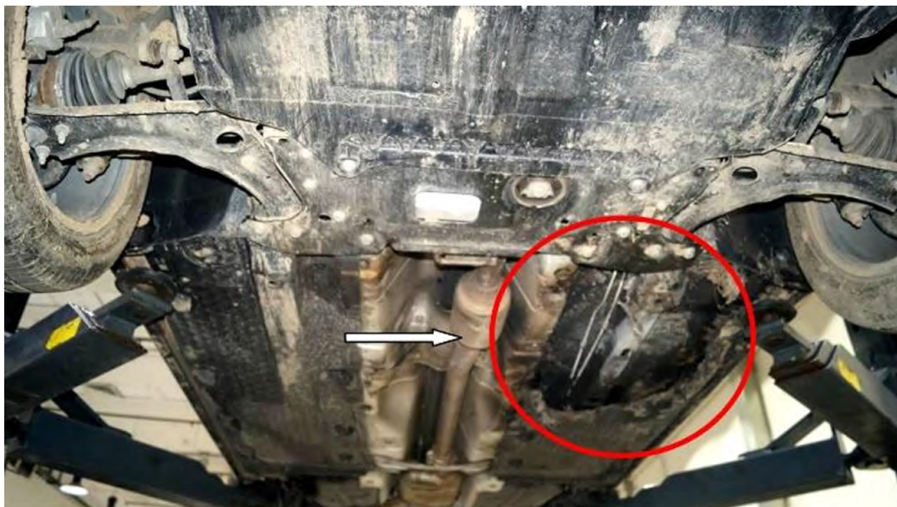
Рис. 4. Последствия неисправности катализатора с последующим возгоранием обшивки
