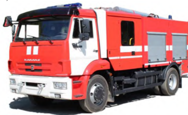
Рис. 1 - Пожарная автоцистерна тяжелого класса АЦ-СПК 3,0-40(43253) с системой NATISK-300KS
