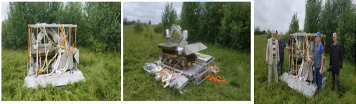
Рис.2 - 30 июня 2021 года на аэродроме МАИ в поселке Алферьево были выполнены впервые выброска самолетом ИЛ-76 парашютным способом мобильный робот «МРК-61»
