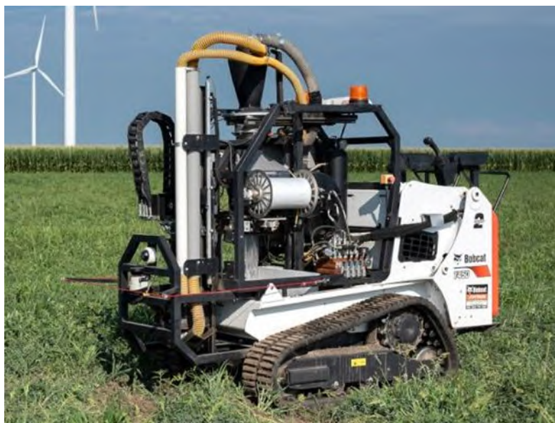
Рис. 3 - Автономный робот-вездеход для отбора почвенных проб
