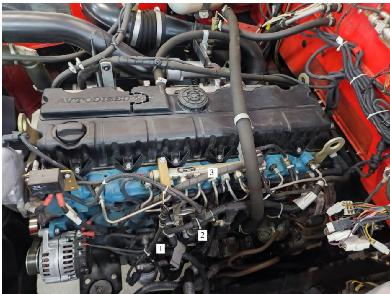
Рис. 5 - Расположение датчиков и устройств двигателя ЯМЗ 53623-10
