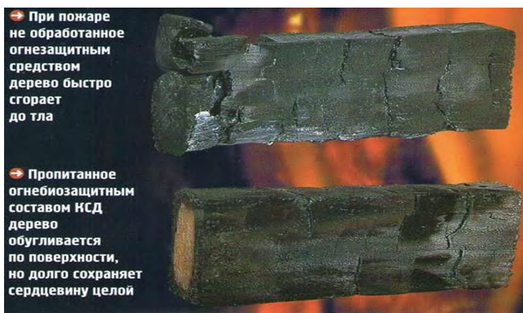
Рис. 3 - Пример применения огнезащитной пропитки дерева
