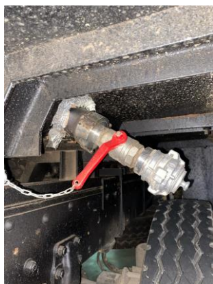
Рис. 6. Шаровой кран на сливное отверстие цистерны
