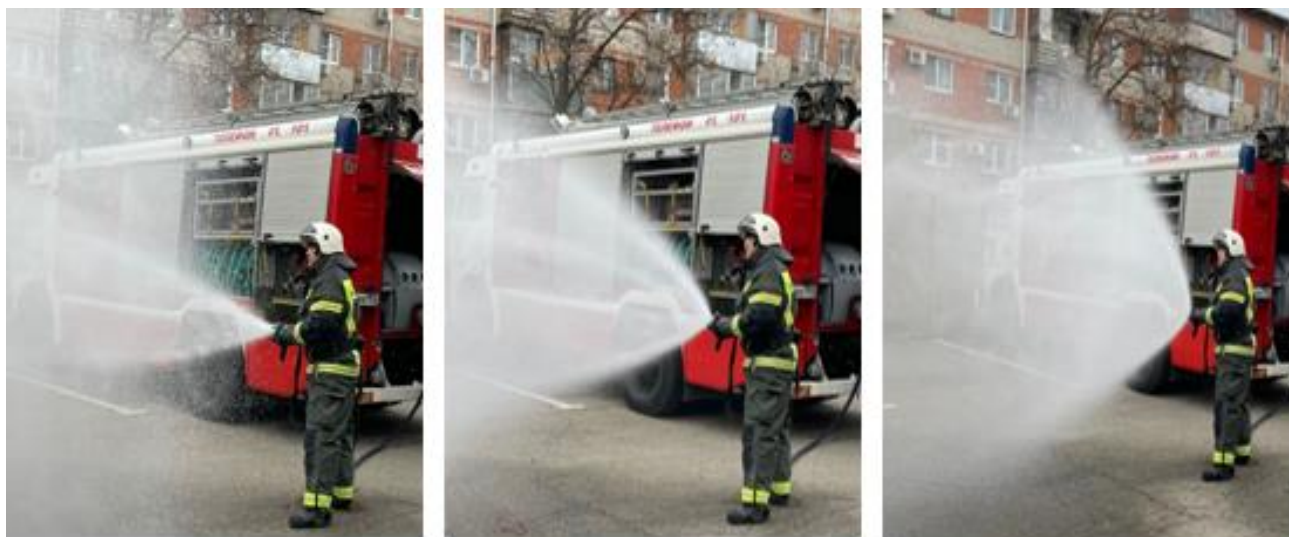
Рис. 5. Испытание комплектации 2: изменение угла подачи распыленной струи с образованием «завеса»
