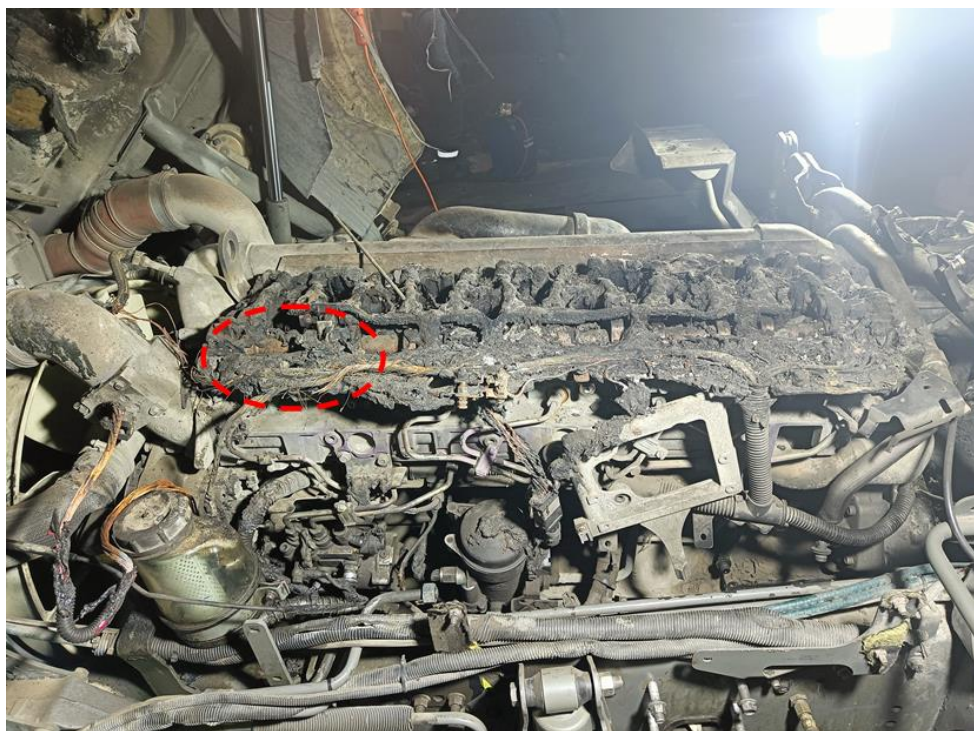
Рисунок 2 – Левая часть двигателя. Красным пунктиром выделены максимальные термические повреждения.
