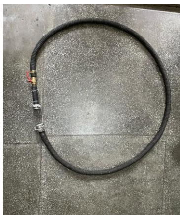
Рис. 5. Устройство для подачи пенообразователя в пеноноситель автомобиля пенного тушения
