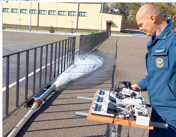
Рис. 2. Фрагмент проведения испытаний Устройства, разработанного для обеспечения безопасности исследователей и сохранности приборов и пожарной техники при проведении гидравлических исследований по определению значений параметров элементов НРС [5; 6]
