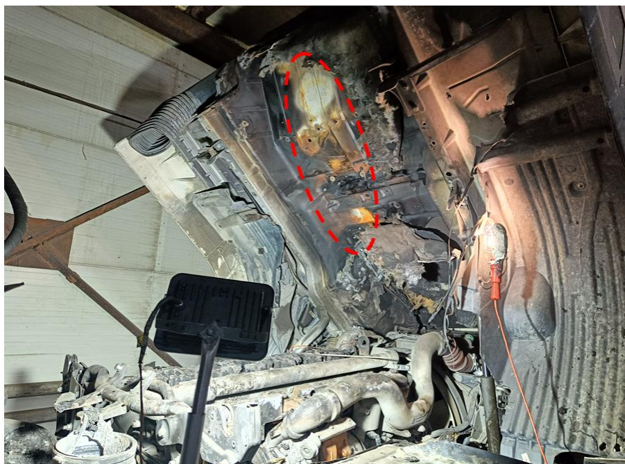
Рисунок 1 – Вид термических повреждений кабины. Красным пунктиром выделены высокотемпературные окислы и повреждения ЛКП.
