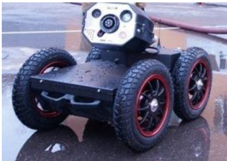
Рис.1- Роботизированная установка пожаротушения
