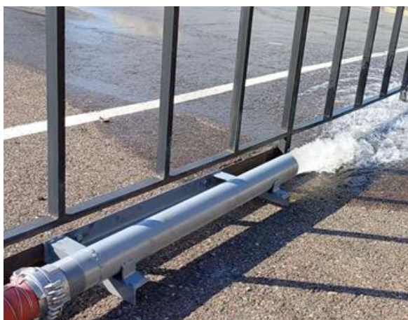
Рис. 2. Фрагмент проведения испытаний Устройства, разработанного для обеспечения безопасности исследователей и сохранности приборов и пожарной техники при проведении гидравлических исследований по определению значений параметров элементов НРС [5; 6]
