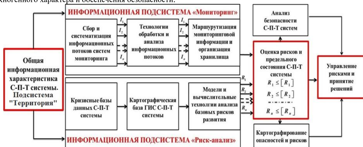
Рис. 1. Блок-схема информационной системы территориального управления рисками и безопасностью (ИСТУ РБ «Регион») [4]
