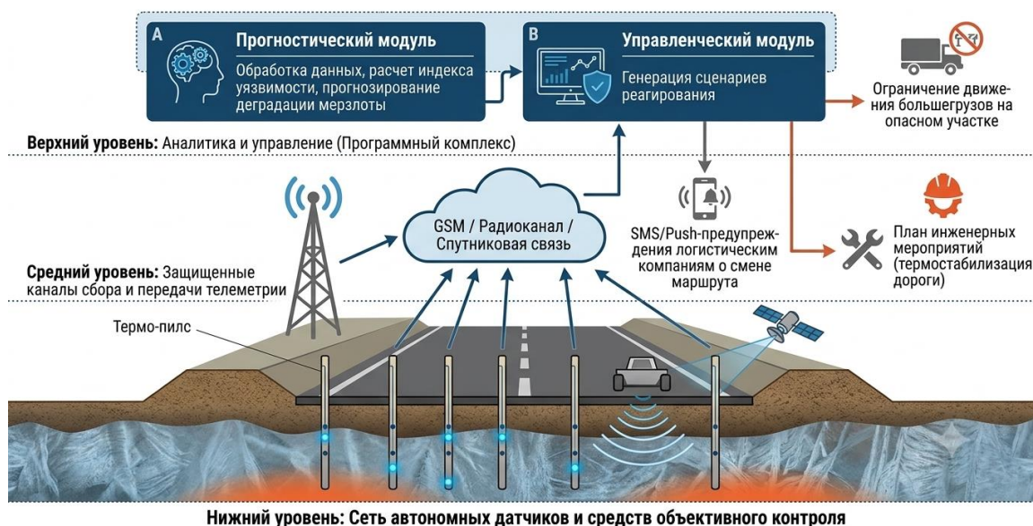
Рис. 1. Структурно-функциональная схема комплексной автоматизированной системы дистанционного контроля транспортной инфраструктуры в криолите.
