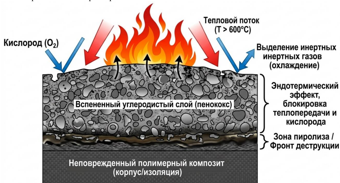
Рис. 2. Теоретическая схема образования интумесцентного барьера на поверхности полимерного композита при воздействии пламени.
