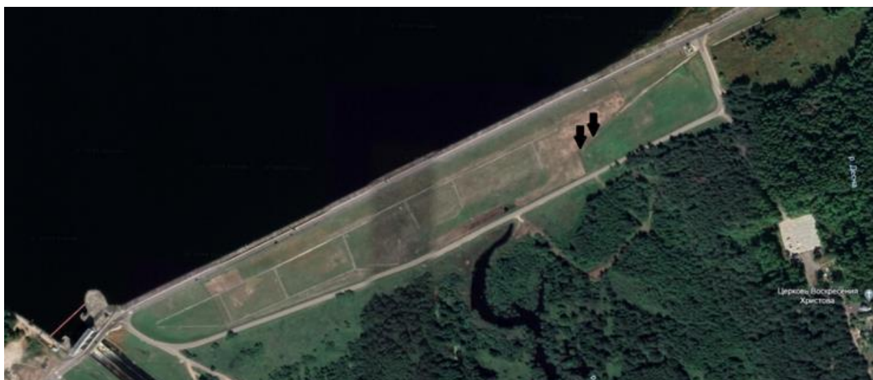
Рис. 2. Общий вид дамбы водохранилища АЭС. Стрелками показаны места формирования грифонов в средней части нижнего бьефа дамбы.
